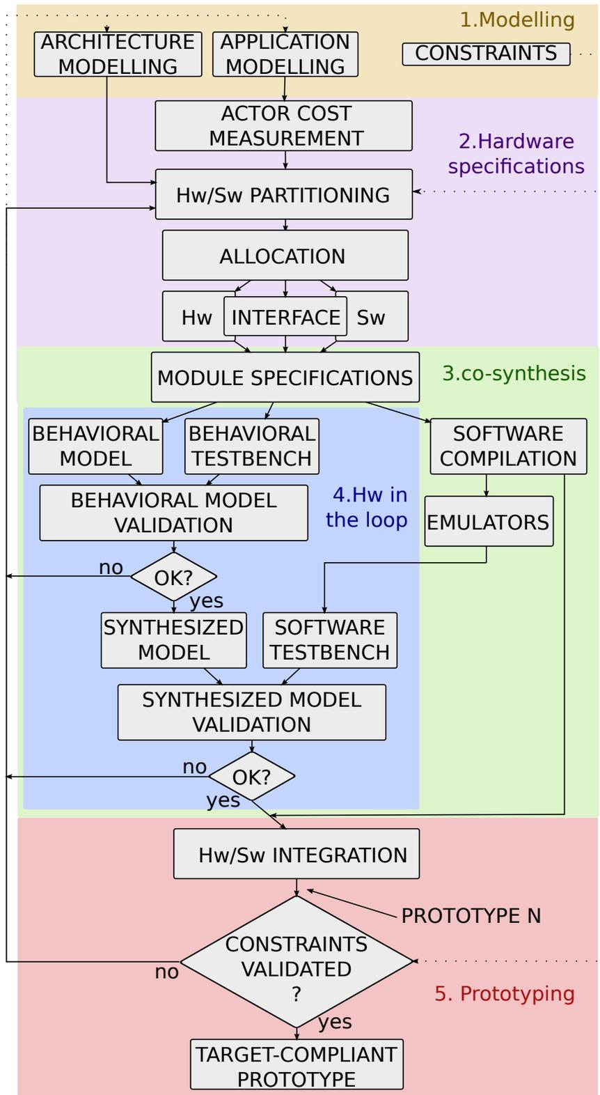
FIGURE 2.25 – Méthodologie de co-design HW/SW appliquée au prototypage d’un EKF-SLAM sur architecture hétérogène.
