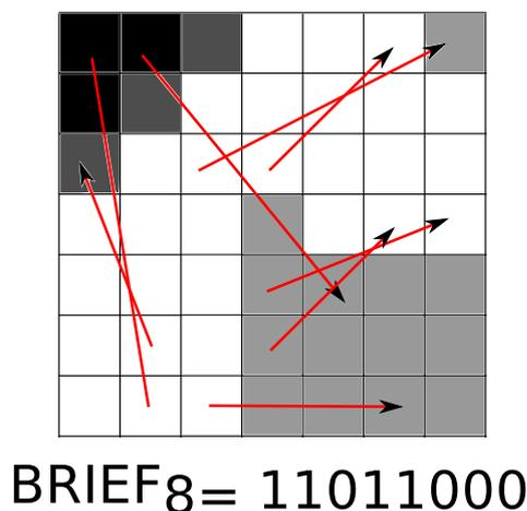
FIGURE 5.25 – Exemple de calcul d'un descripteur BRIEF 8 bits.
