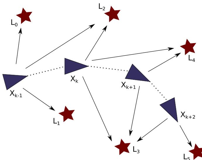
FIGURE 2.1 – Illustration du principe du SLAM. A chaque instant le robot (représenté par une flèche) perçoit des amers ( $L_n$  pour la traduction anglaise de landmarks, symbolisés par des étoiles) grâce à ses capteurs. Si ces amers ont été déjà observés auparavant, le robot effectue une ré-observation de ces points. D'après ces données, il peut affiner sa position dans la carte et celle des amers.
