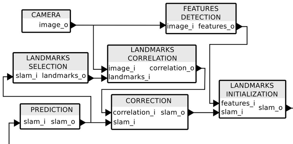
FIGURE 3.4 – Graphe fonctionnel de l'application vision EKF SLAM.
