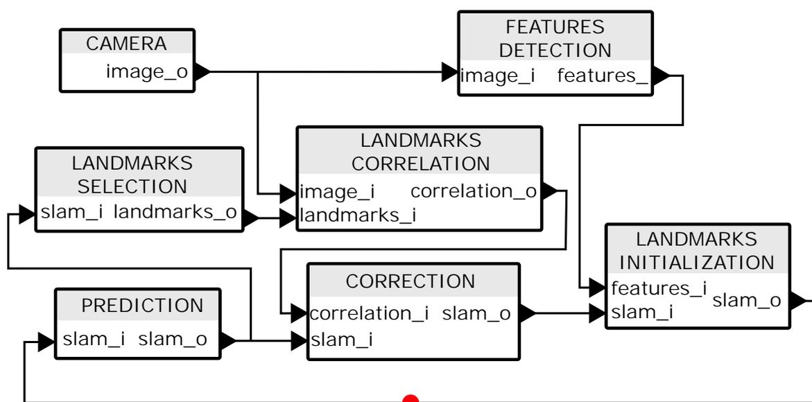
FIGURE 2.7 – Architecture structurelle de C-SLAM.
