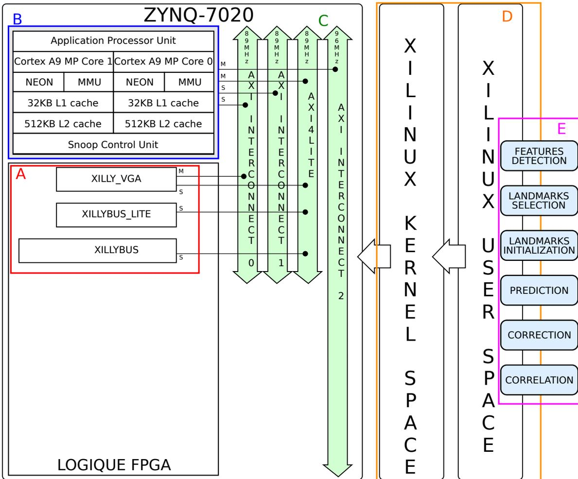
FIGURE 3.12 – Architecture de C-SLAM embarqué sur ZynQ®.
