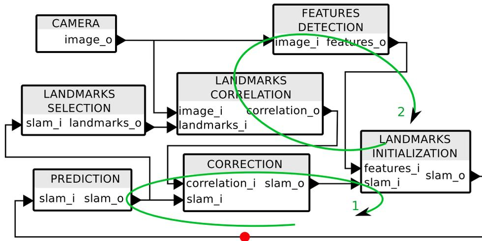
FIGURE 3.6 – Graphe HSDF de l'application vision EKF SLAM.
