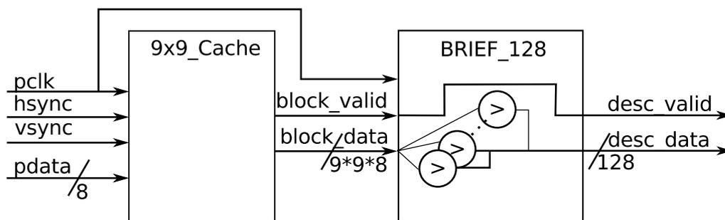
FIGURE 5.27 – Architecture d'extraction du descripteur BRIEF 128 bit.
