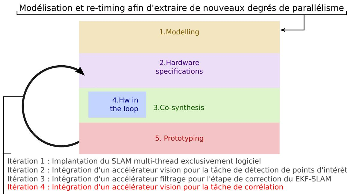
FIGURE 5.24 – Quatrième itération de méthodologie de co-design effectuée avant d'obtenir un système EKF-SLAM qui satisfait les contraintes imposées.
