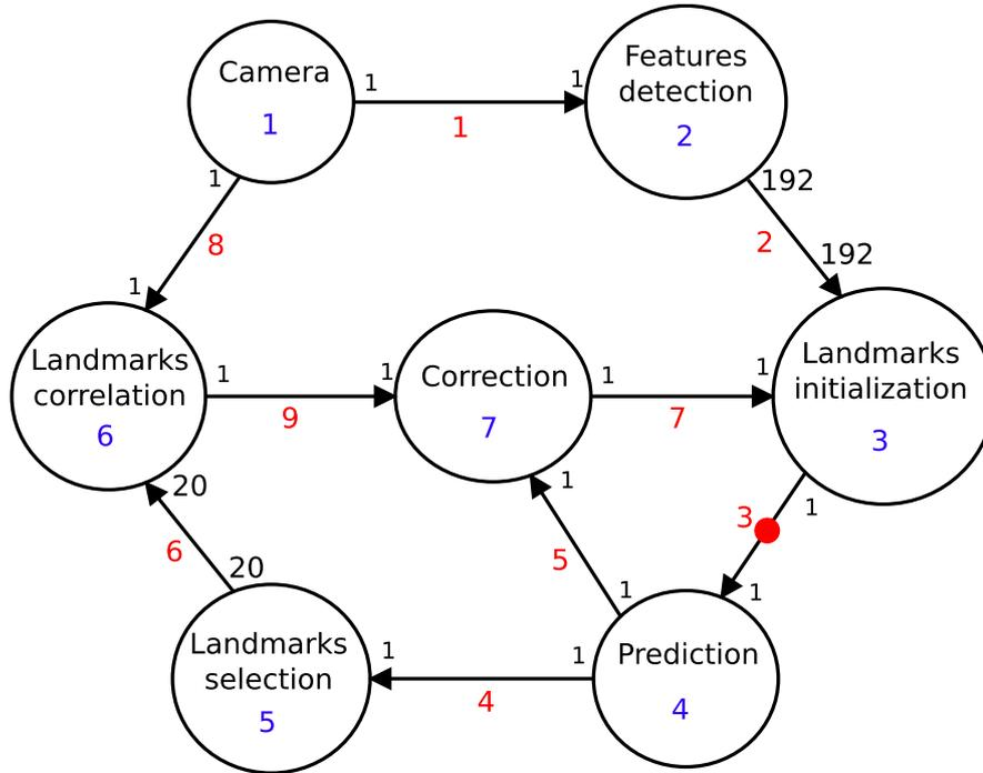
FIGURE 3.5 – Modèle SDF de l’application vision EKF SLAM.
