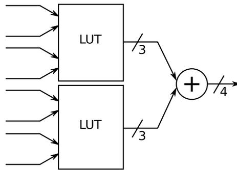
FIGURE 5.31 – Exemple du calcul de la distance de Hamming d'un mot 8 bits basé LUT.
