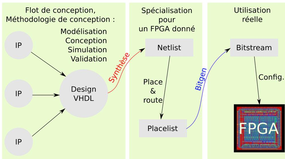
FIGURE 2.23 – Chaîne de développement FPGA.
