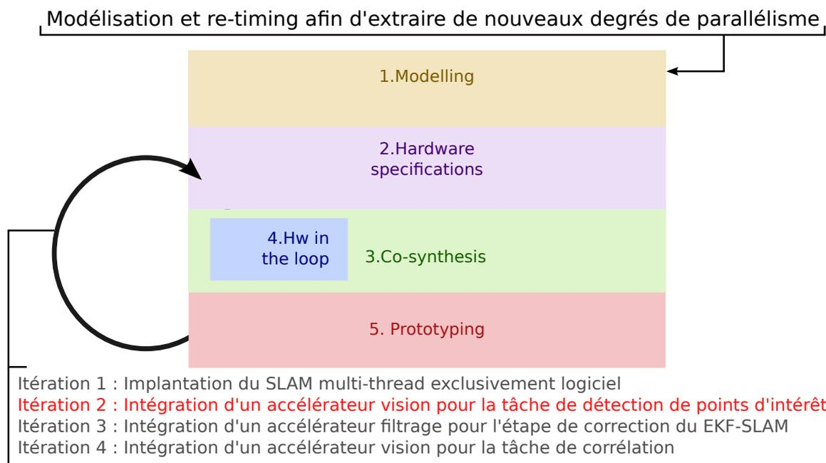
FIGURE 5.1 – Les différentes itérations de la méthodologie de co-design effectuées avant d'obtenir un système qui satisfait les contraintes imposées.
