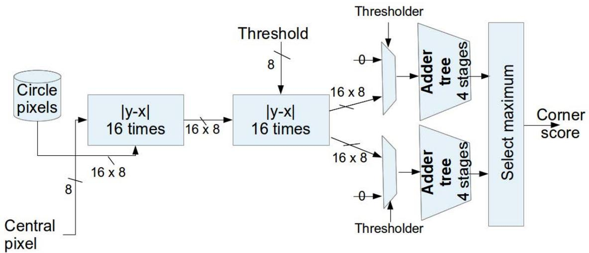
FIGURE 5.7 – Module de calcul du score de FAST.
