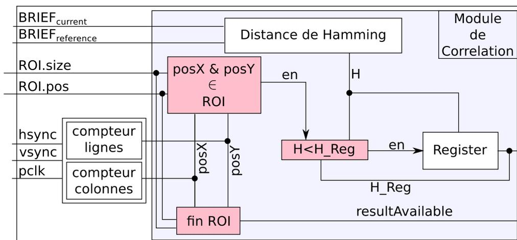
FIGURE 5.33 – Architecture d'un processeur de corrélation.
