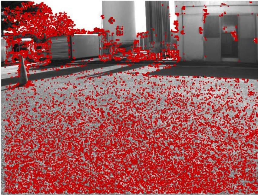
FIGURE 5.10 – Résultats du détecteur de coin FAST sur architecture matérielle.
