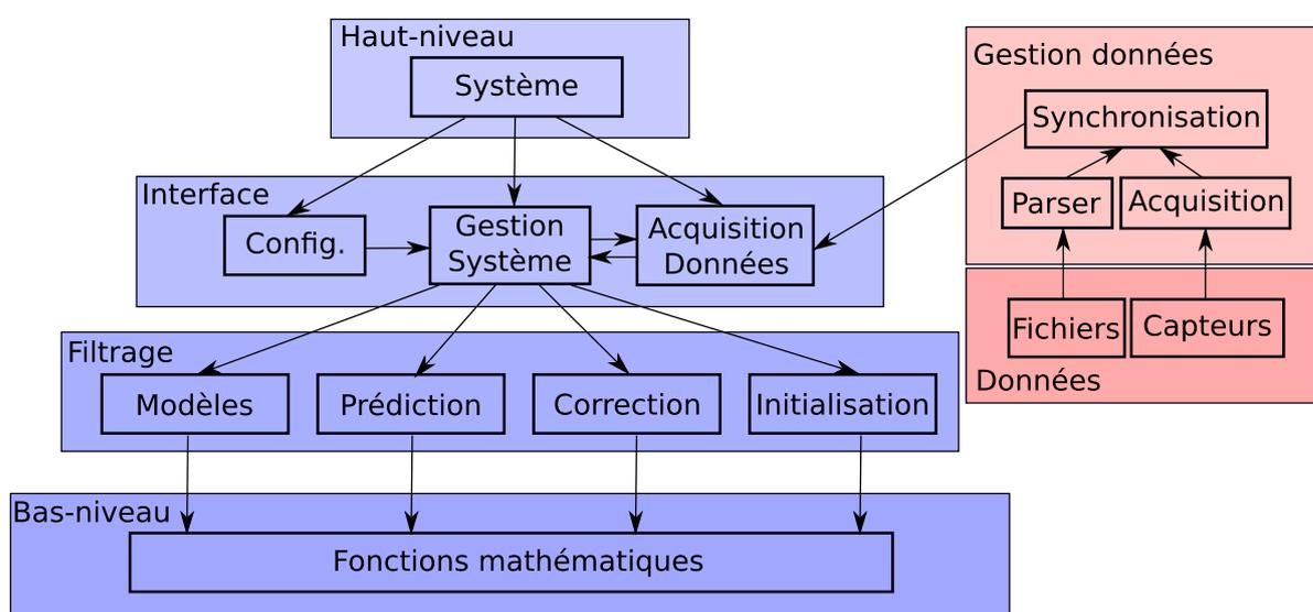
FIGURE 2.6 – Architecture de l'algorithme C-SLAM.
