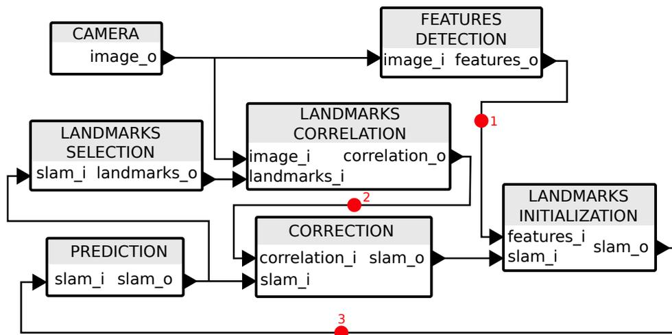
FIGURE 3.10 – Modèle SDF réordonnée de l'application EKF-SLAM
