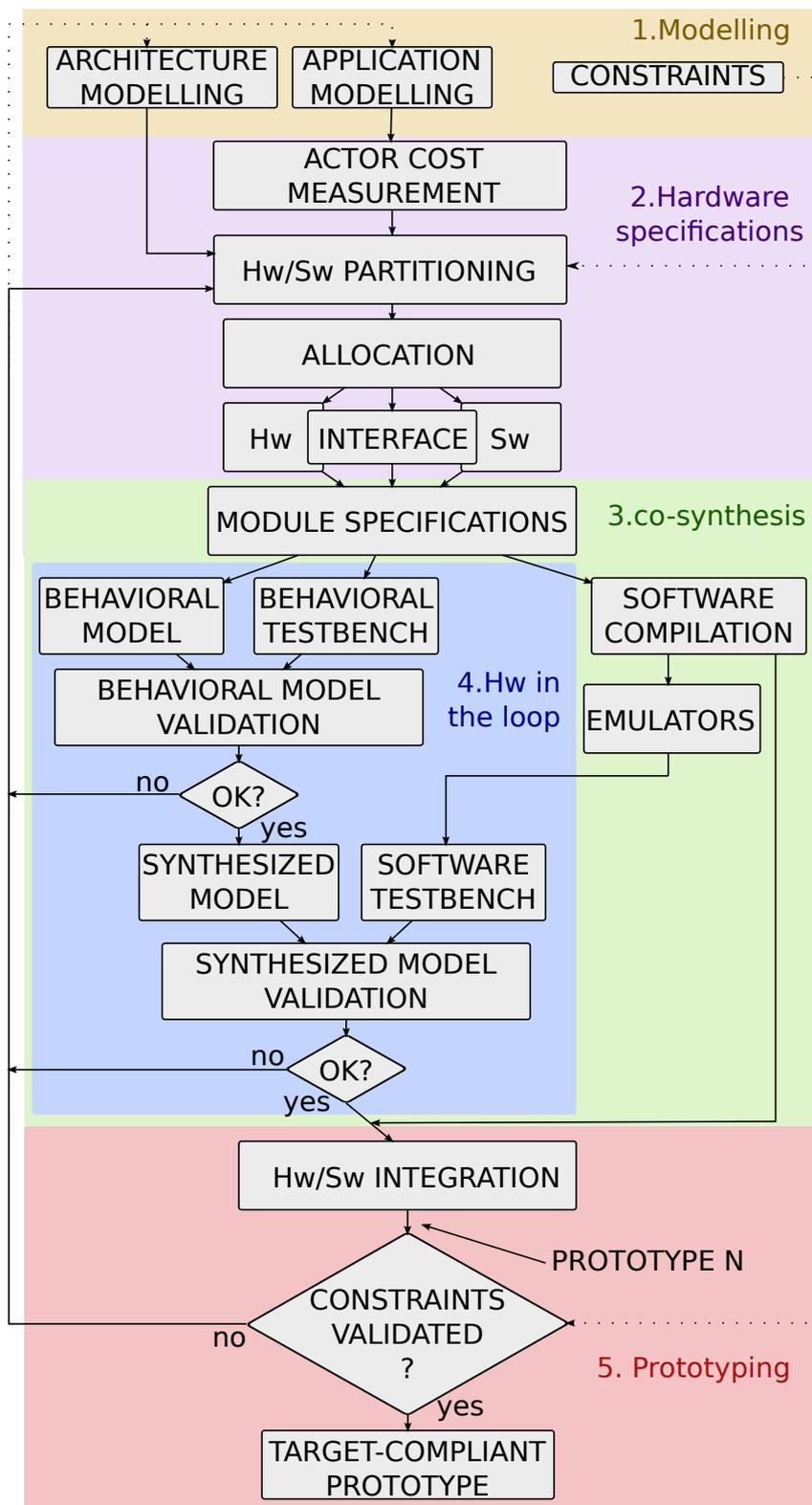
FIGURE 3.2 – Méthodologie de co-design HW/SW appliquée pour le prototypage d'un EKF-SLAM sur architecture hétérogène.
