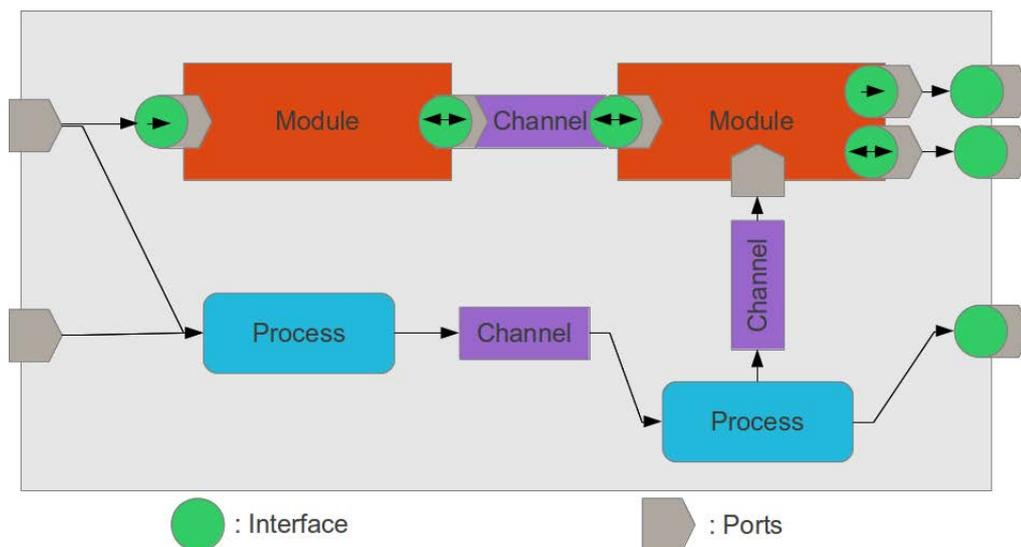
FIGURE A.1 – Diagramme d'un module en SystemC
