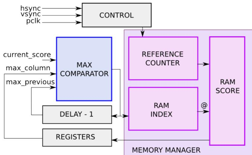
FIGURE 5.20 – Architecture matérielle de l'algorithme de Non-Maxima Suppression.
