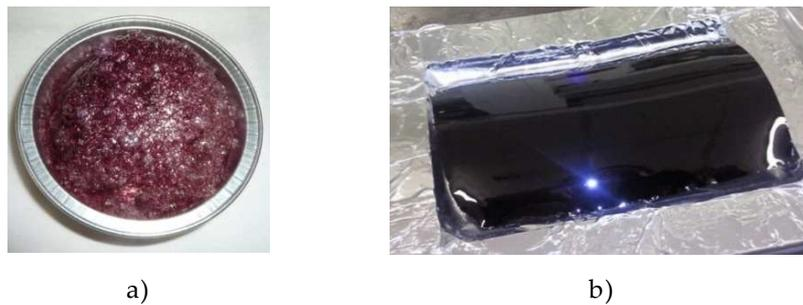
Figure II-13 : Résine phénolique réticulée ; sans pallier préalable (a) ; avec pallier préalable à 70 °C (b).
