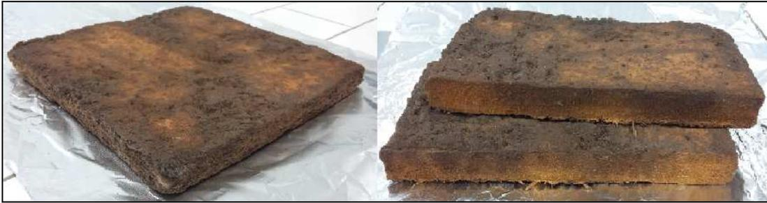
Figure III-74: Photographie du composite après cuisson, exemple avec 10 % d'Expancel®.
