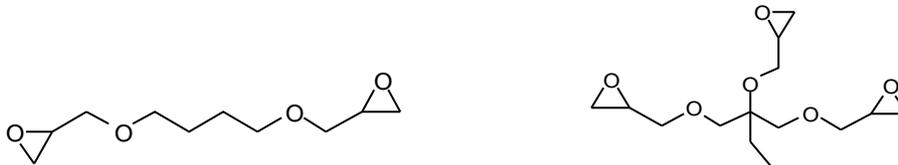
Figure III-17 : Diluants réactifs époxydes ; diglycidylether de butanediol (à gauche) et triglycidylether de triméthylolpropane (à droite)
