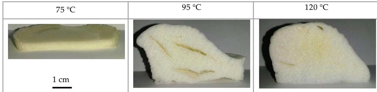
Figure IV-42 : Photographies des mousses du mélange [TETM/IPDA+10%BS] à des températures de cuisson différentes
