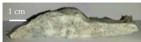
Figure IV-63 : Photographie de la mousse du mélange [TETM/IPDA+10%BS] contenant 10% de fibres courtes de basalte, cuisson à T=95 °C.
