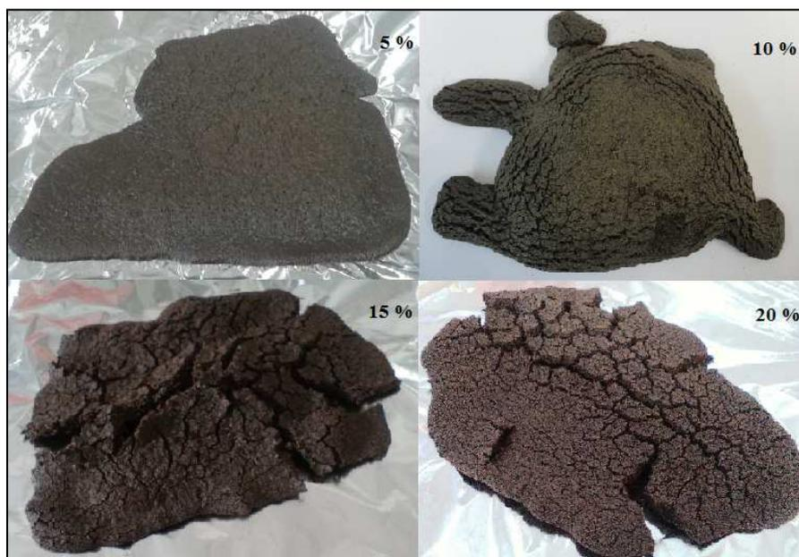
Figure III-53 : Photographies des mousses TETM/DDS + Expancel® 950 avec différentes proportions d'Expancel®.
