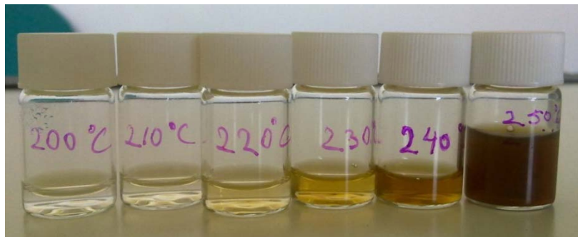
Figure 3-3 : Variation de la couleur des échantillons prélevé au cours de la phase de montée en température d'une solution de glucose à 0,5% en masse, sans catalyseur.
