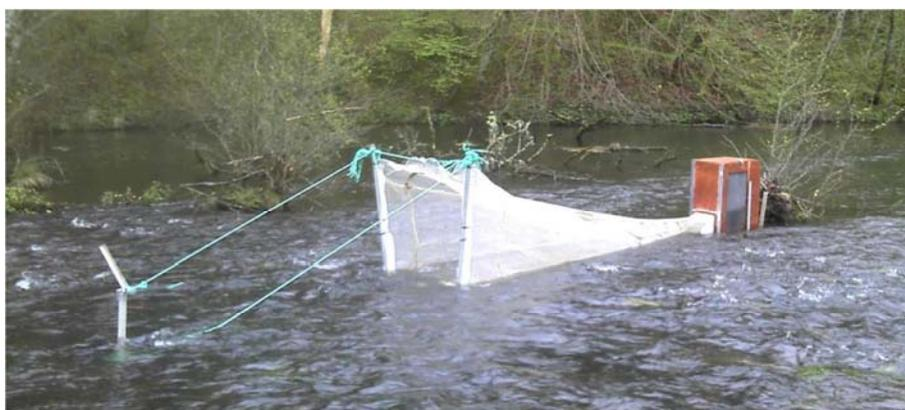
Figure 95 : Photographie du dispositif fixe d'échantillonnage en service en amont du pont de la Broquerie sur la Maronne (figure extraite de Clave et al. 2013).
