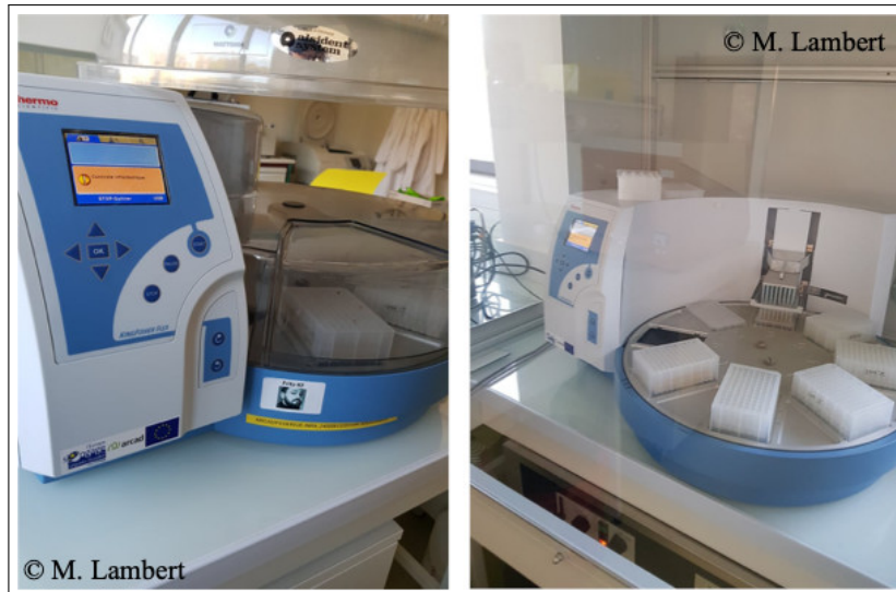
FIGURE 28: Automatisation des expérimentations avec le robot KingFisher
