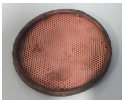
Figure 5.1 : Distributeur recouvert de cuivre à la suite d'un dépôt CVD
