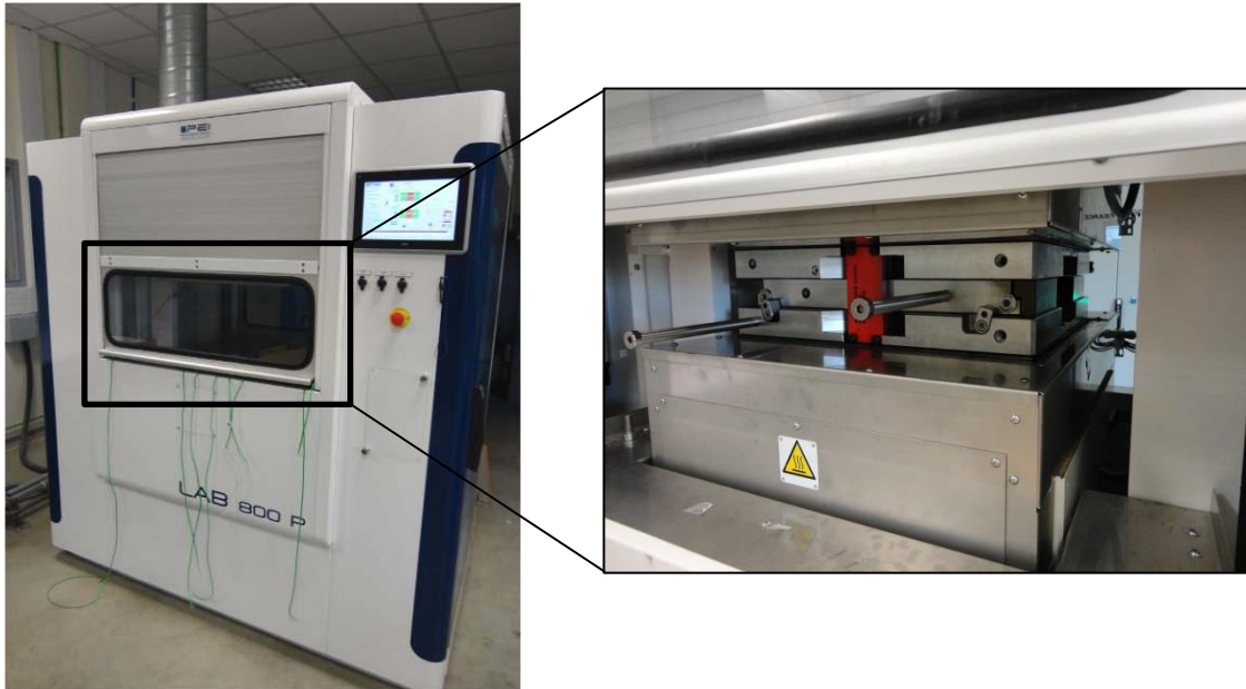
Figure E.4 : Photographie de la presse à plateaux chauffants avec une vue rapprochée des plateaux en position fermée
