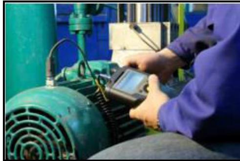
**Figure 5. 16 Méthode manuelle pour la surveillance des vibrations**
