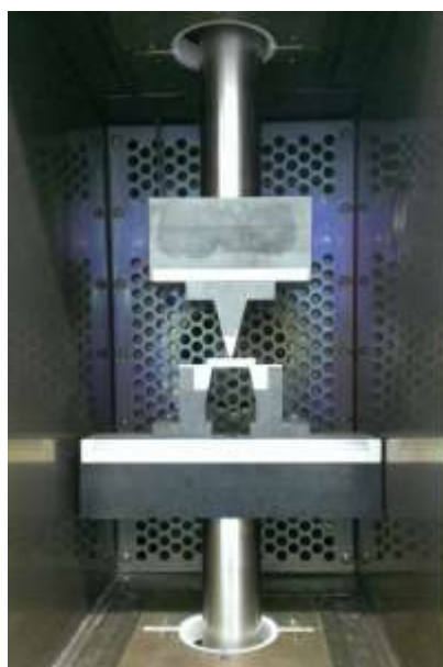
Figure 20 : Dispositif d'essais Charpy Quasi Statique
