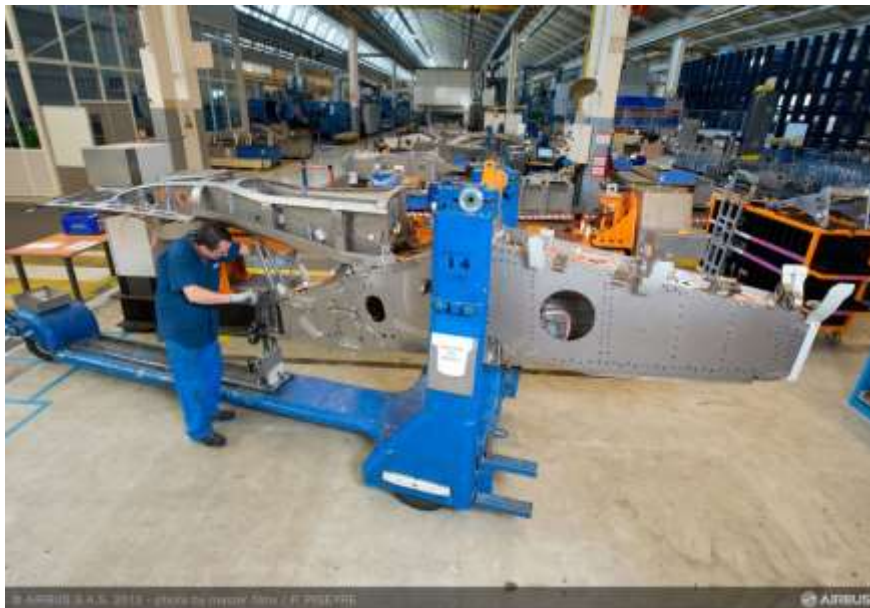
Figure 2 : Mat réacteur sur chaîne de montage à l'usine de Saint Eloi de Toulouse (31). La partie porteuse du mât correspond au caisson fermé.
