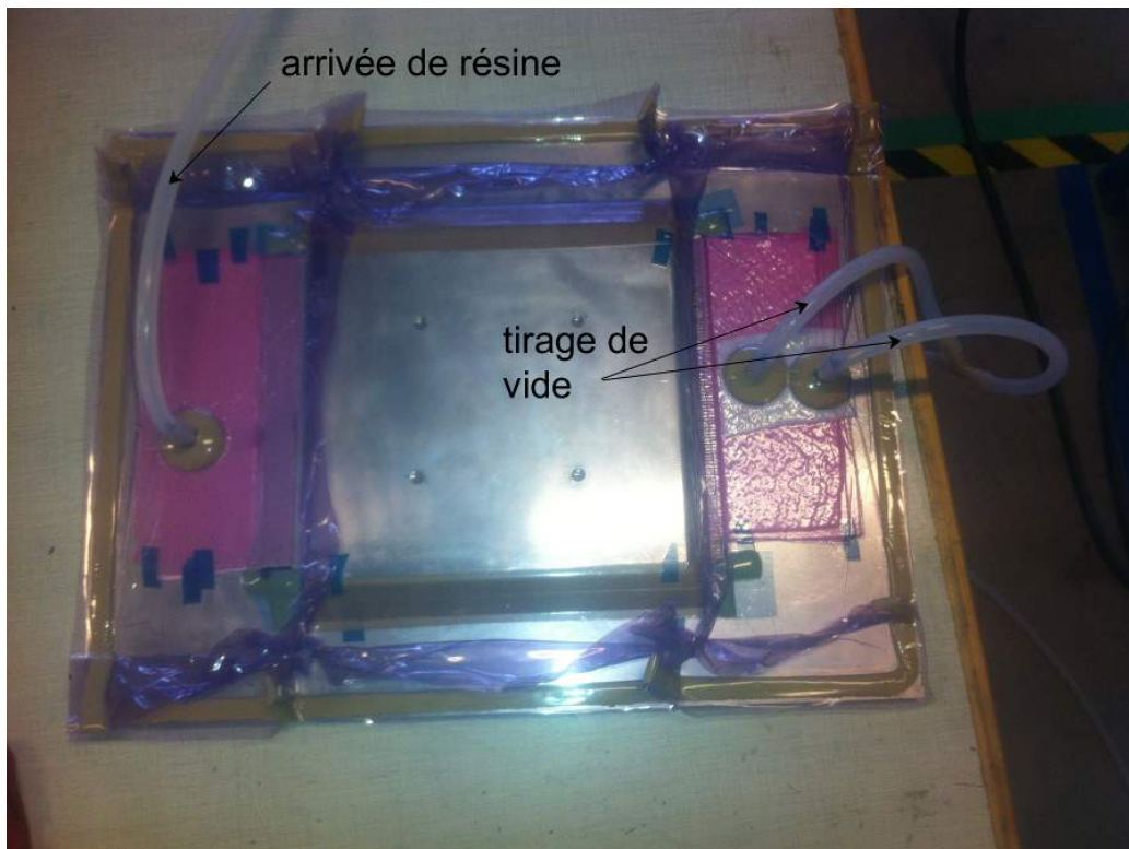
FIGURE 3.24 – Dispositif d'infusion pour le composite G926/RTM6
