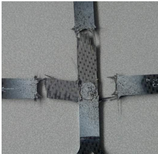
FIGURE 5.16 – Rupture d'une éprouvette cruciforme après 1 million de cycles
