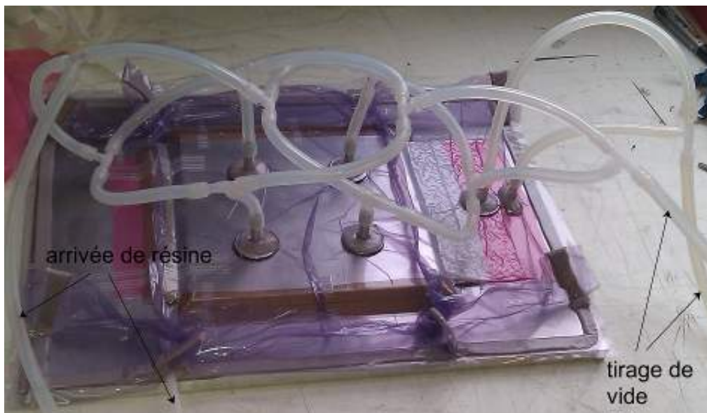
FIGURE 3.23 – Dispositif d'infusion pour le composite 48302/SR1710
