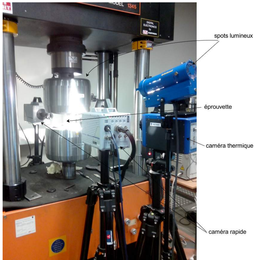
FIGURE 4.11 – Dispositif pour le suivi d'essai de fatigue uni-axial
