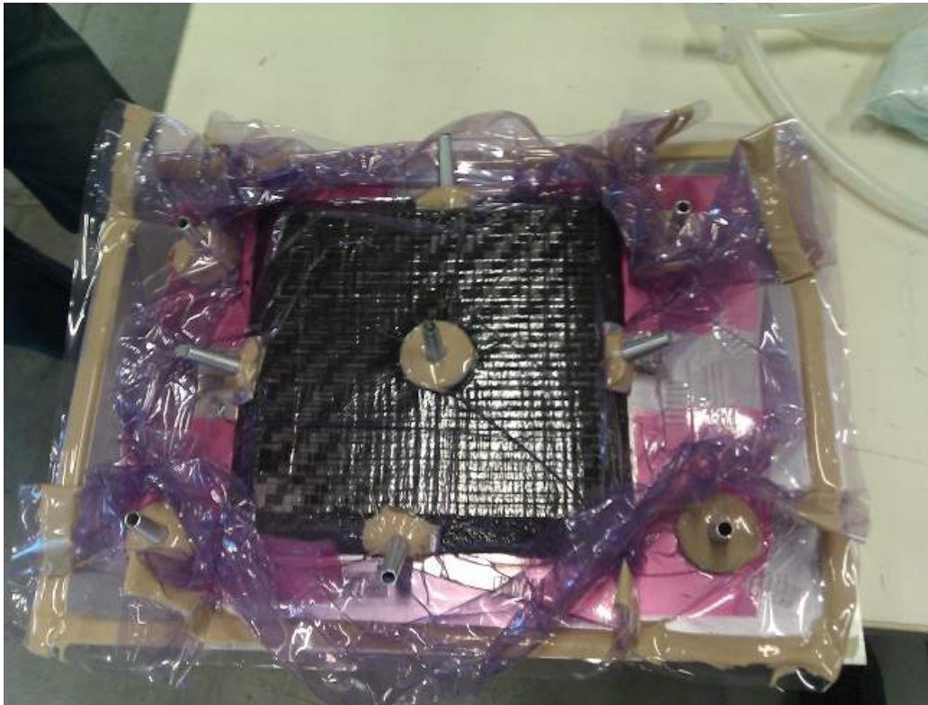
FIGURE 1.17 – Réalisation d'une éprouvette épaisse en composite par LRI
