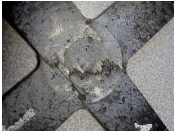
FIGURE 3.26 – Rupture éprouvette bi-axiale en statique
