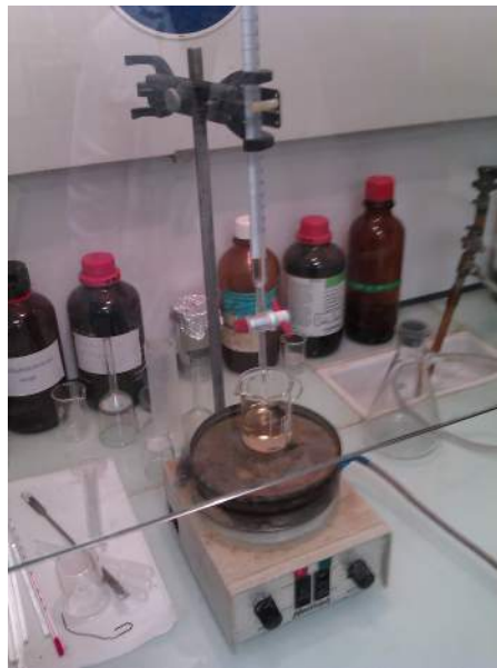
FIGURE 1.20 – Montage pour une dissolution de résine
