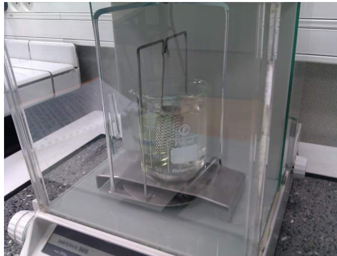
FIGURE 1.19 – Montage pour une mesure de densité
