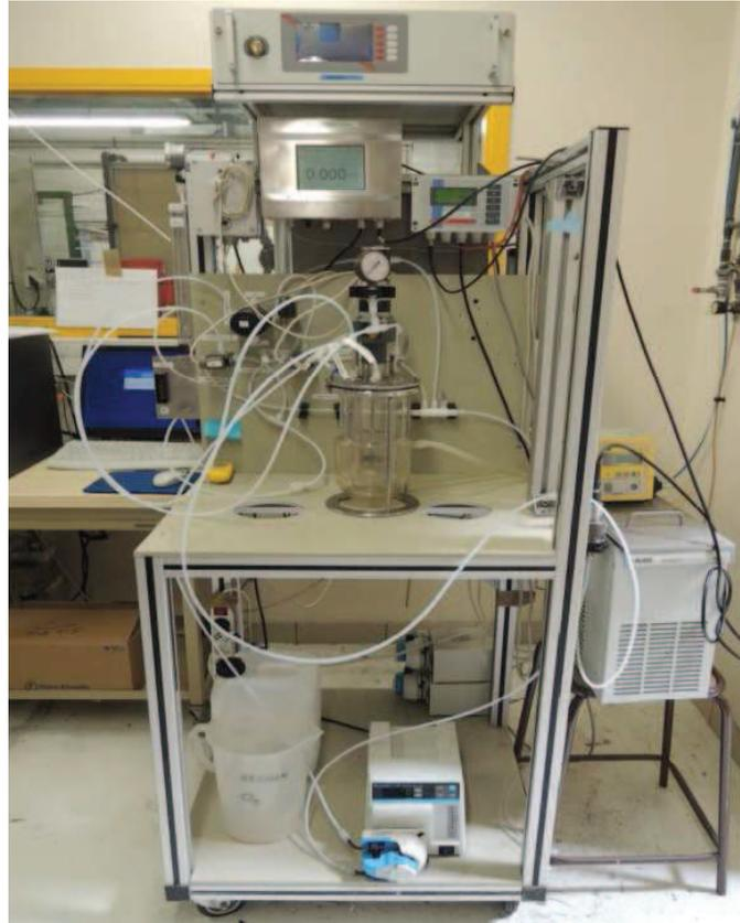
Figure II.3 Photographie du réacteur agité semi-batch.
