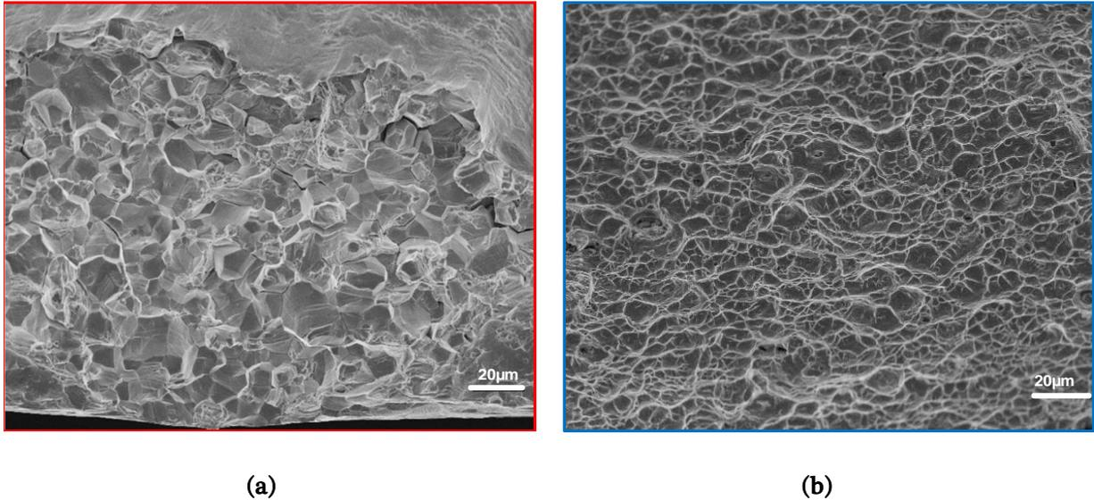
Figure III-35 Modes de rupture observés post-mortem sur le faciès d'une éprouvette de traction (essai réalisé à 650°C/10<sup>-3</sup>s<sup>-1</sup>) : zone à caractère intergranulaire fragile (a) et zone à caractère transgranulaire ductile (b)
