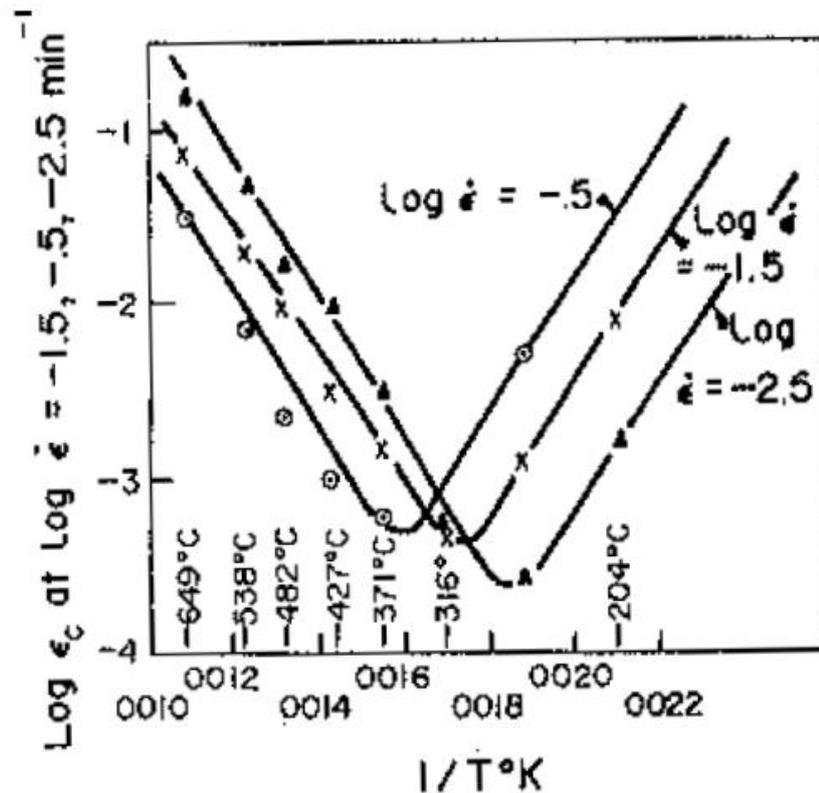
Figure I-30 Evolution de  $\varepsilon_c$  en fonction de la température dans le Waspaloy pour différentes vitesses de déformation : mise en évidence des tendances d'évolutions normale et inverse de  $\varepsilon_c$ , d'après [Hayes 1982]
