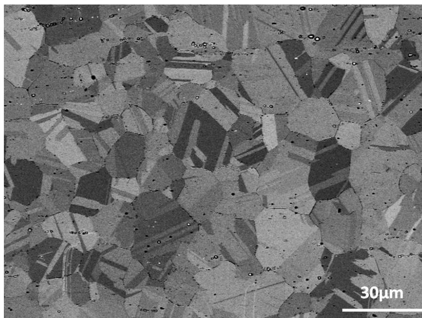
Figure II-4- Microstructure de l'alliage 718 enrichi en Molybdène après remise en solution 1 heure à 1060°C, observation en MEB en électrons rétrodiffusés après attaque électrochimique à l'acide oxalique 10% (5V)
