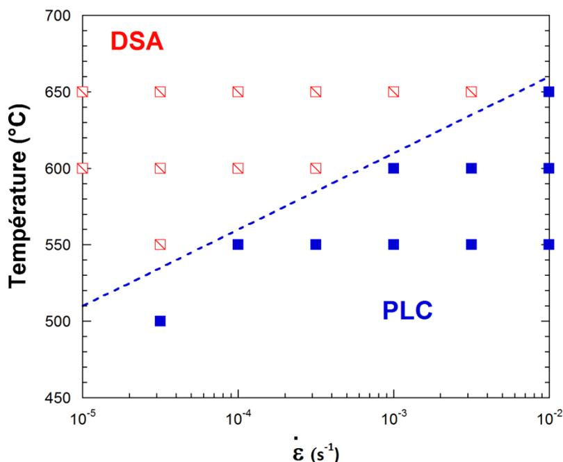
Figure III-10- Campagne d'essais de traction pratiqués sous vide secondaire ( $5 \times 10^{-5}$  mbar) sur l'alliage 718 à l'état vieilli. La frontière représentée est celle définie par les essais pratiqués sous air, et correspond à la transition DSA – PLC sous vide.
