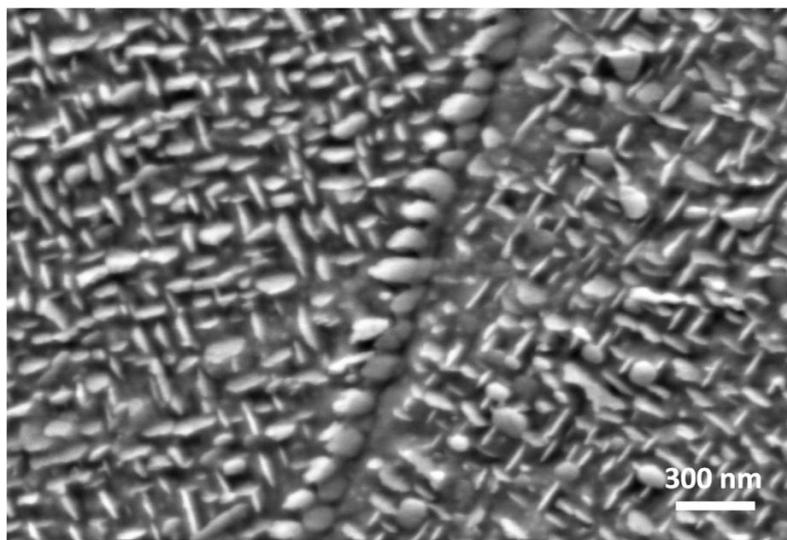
Figure I-4 Précipitation des phases durcissantes  $\gamma'$  et  $\gamma''$  dans l'alliage 718 à l'état vieilli dans deux grains adjacents. Le joint séparant ces deux grains présente une précipitation forte de phase  $\gamma''$  en cours de stabilisation par transformation en phase  $\delta$ , cliché en MEB-FEG par J.-M. Cloué.
