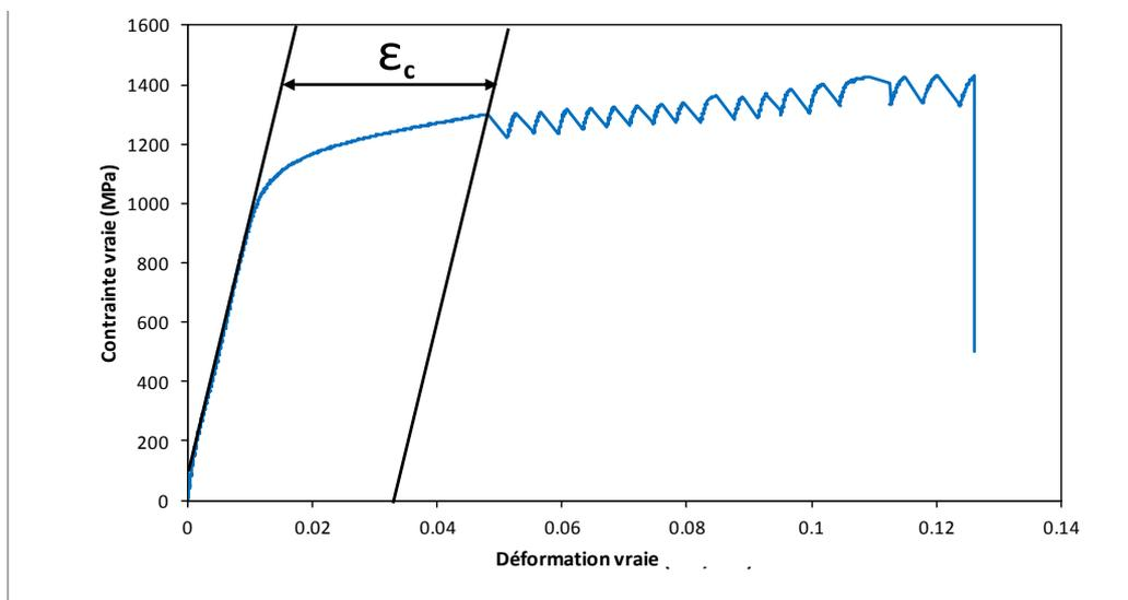
Figure I-29 Courbe contrainte vraie-déformation vraie d'un essai de traction pratiqué à 550°C et  $10^{-4}s^{-1}$  sur l'alliage 718 à l'état vieilli : mise en évidence de l'existence d'une déformation plastique critique  $\epsilon_c$  avant apparition des instabilités de l'écoulement plastique
