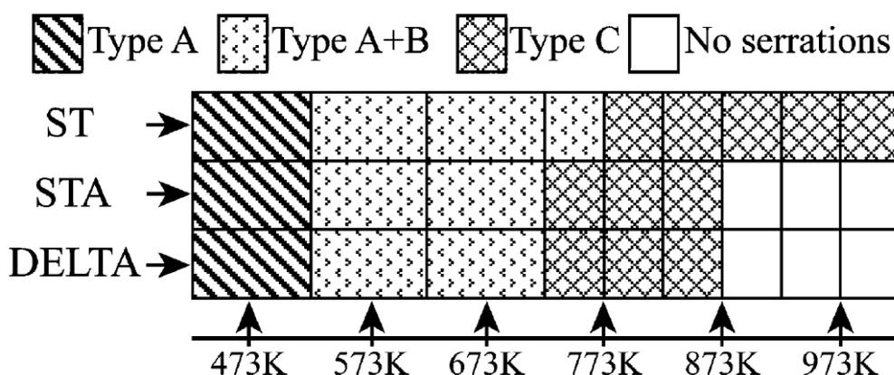
**Figure I-33 Effet de l'état métallurgique sur les domaines d'occurrence de différents types d'effet PLC dans l'alliage 718 en fonction de la température d'essai pour une vitesse de déformation  $\dot{\epsilon} = 6.5 \times 10^{-5} s^{-1}$  (ST = Solution solide, STA = Vieillissement aéronautique et DELTA = précipitation de phase delta)**
