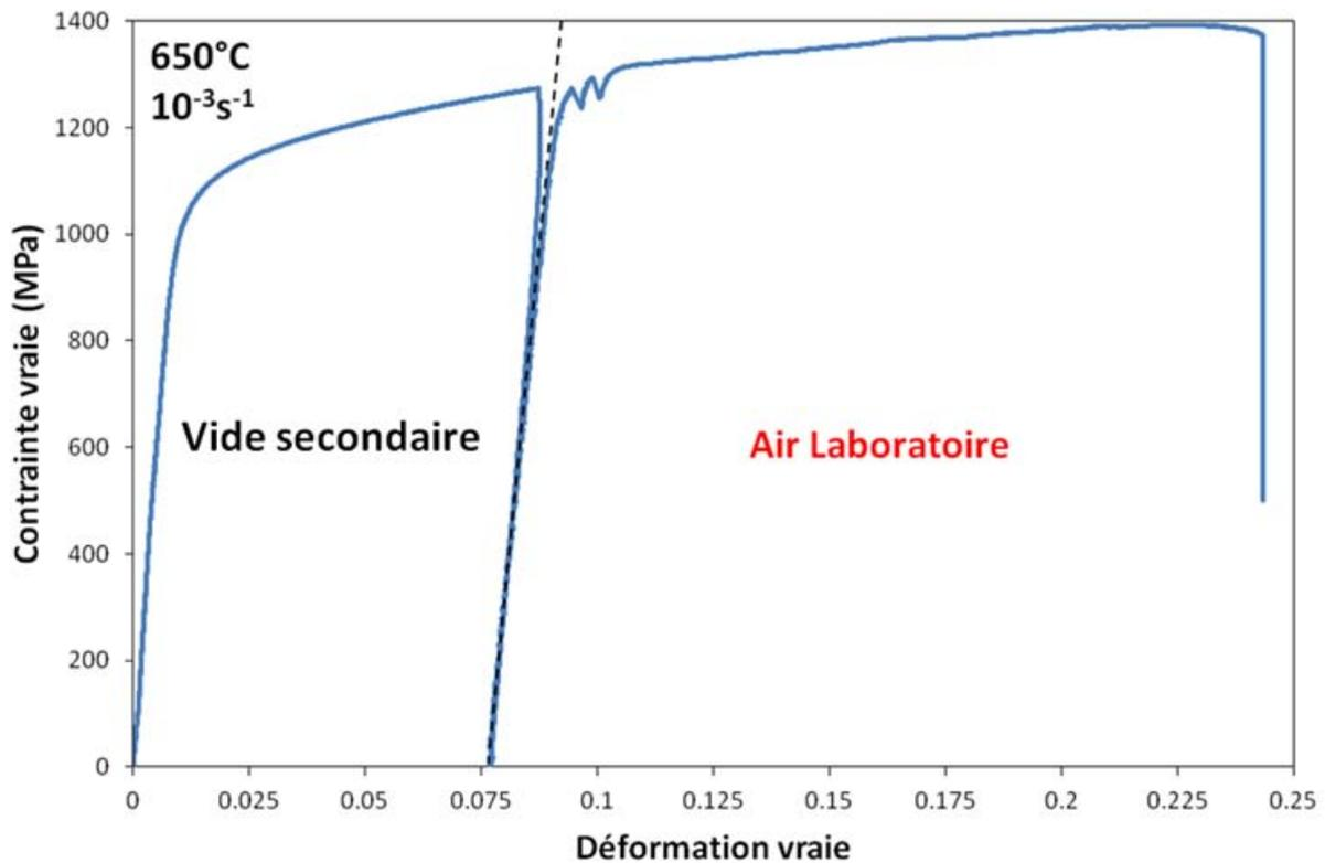
Figure III-51 Essai de traction à 650°C et 10<sup>-3</sup>s<sup>-1</sup> avec changement d'atmosphère en cours d'essai : vide secondaire puis air laboratoire et polissage de l'éprouvette entre les deux phases d'essai.
