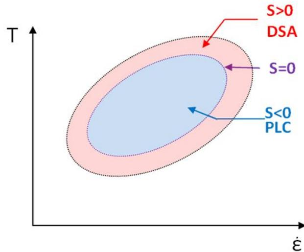
Figure I-18 Schéma des domaines de DSA et d'occurrence de l'effet PLC dans une représentation température – vitesse de déformation en lien avec le paramètre  $S$  de sensibilité de la contrainte d'écoulement à la vitesse de déformation.
