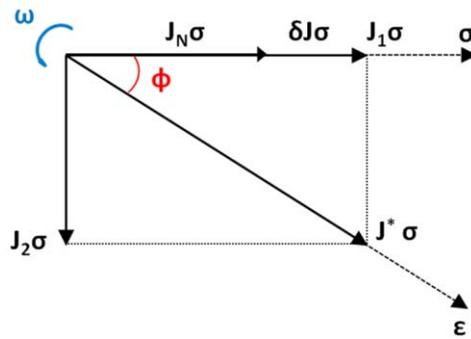
Figure III-19 Diagramme vectoriel montrant la relation de phase entre la contrainte, la déformation et la souplesse complexe. Le diagramme tourne autour de son origine à une fréquence angulaire  $\omega$
