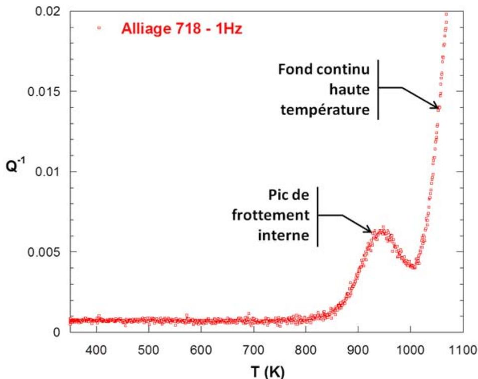
Figure III-22- Spectre de frottement intérieur brut typique de l'alliage 718 par balayage en température pour une fréquence d'oscillations de 1Hz
