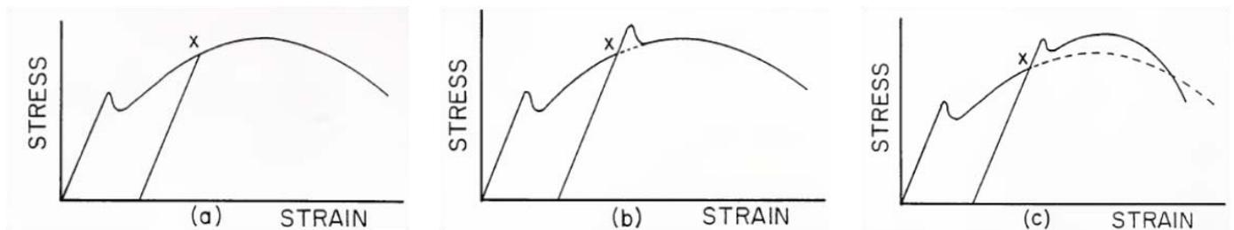
**Figure I-14 : Représentation schématique de différentes phases du vieillissement statique : Temps de vieillissement nul (a), temps de vieillissement court (b), et temps de vieillissement long (c), d'après [Beckerman 1980]**
