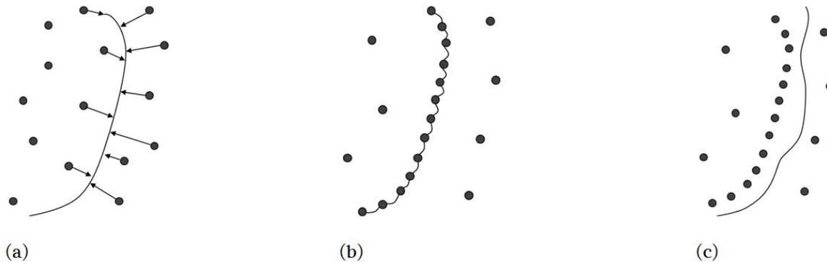
**Figure I-24** Schéma du mécanisme à l'origine de l'effet PLC selon Cottrell [Cottrell 1953], diffusion des atomes solutés vers la dislocation en mouvement (a), ancrage de la dislocation (b) et libération soudaine de la dislocation de son atmosphère de solutés (c) sous l'effet d'une contrainte appliquée croissante
