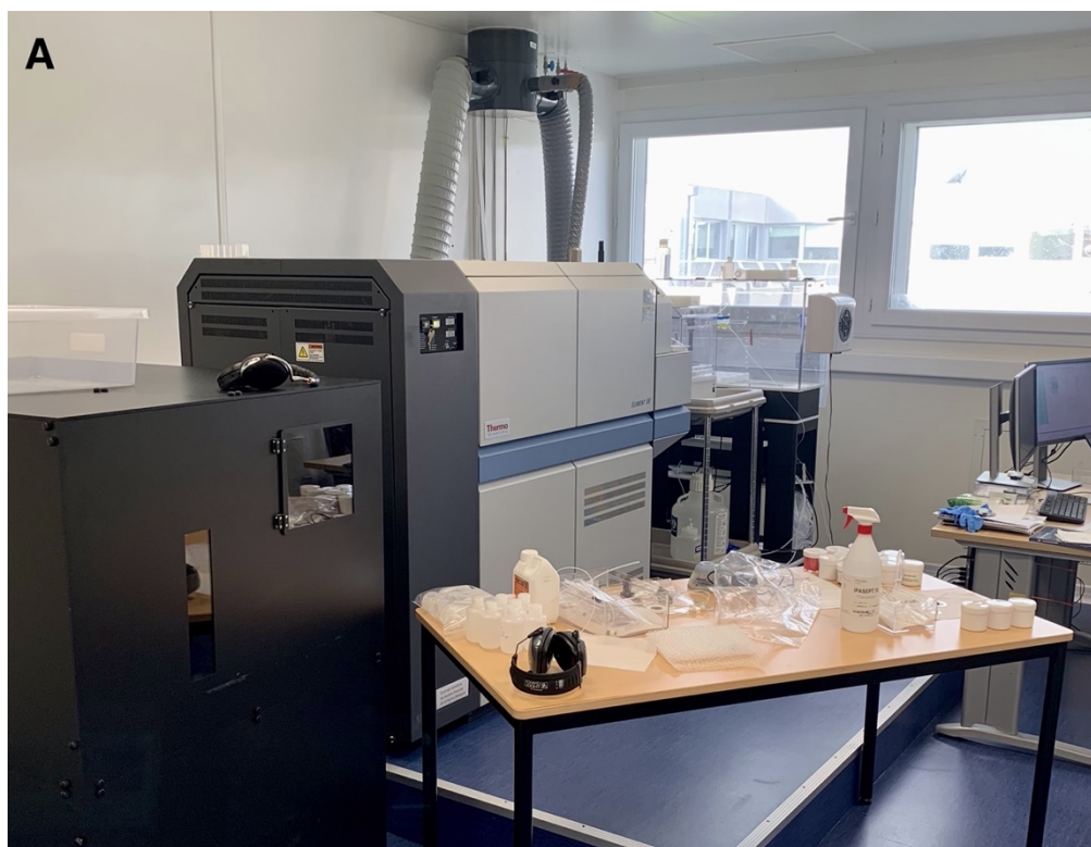
Figure 27 - a) ELEMENT XR High-resolution Multi-collector ICP-MS from the Pôle Spectrométrie Océan (PSO) at l' Institut Français de Recherche pour l'Exploitation de la Mer (IFREMER). b) ICP-MS autosampler, carrying samples and solutions used for measurements
