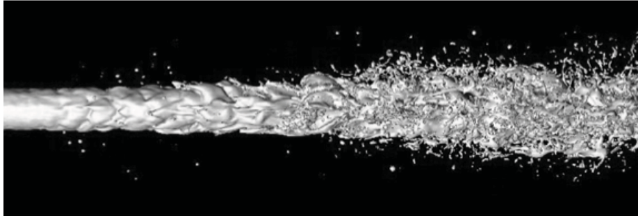
Figure 3.2: Simulation du processus d'injection par une méthode suivi d'interface (Menard et al. (2007))
