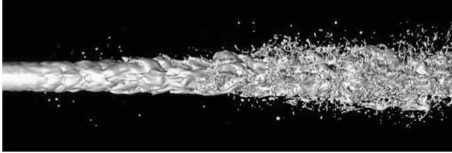
Figure 3.2: Simulation du processus d'injection par une méthode suivi d'interface (Menard et al. (2007))
