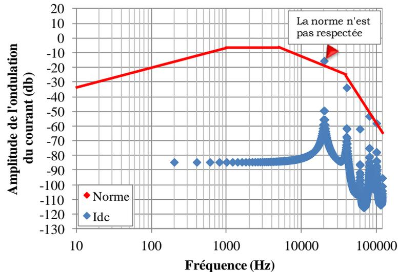
Fig. 86 Spectre harmonique du courant  $I_{dc}$  ( $L_f=100\mu\text{H}$ ,  $C_f=10\mu\text{F}$ )
