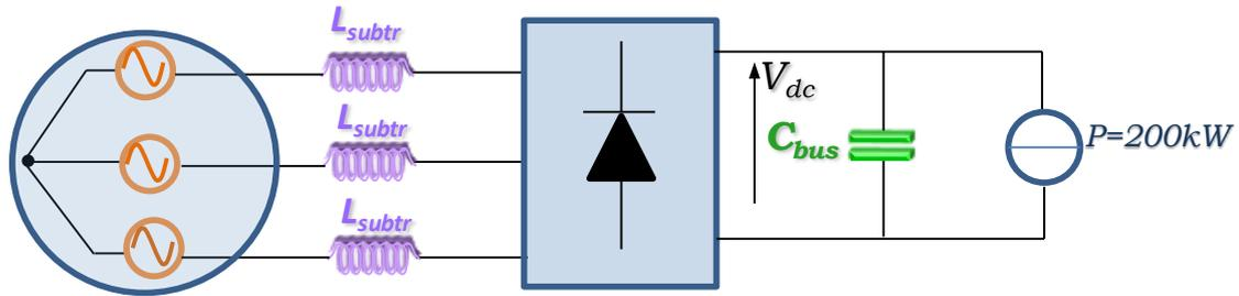
Fig. 87 Circuit du système : Source triphasé redressée+Cbus+Equipement
