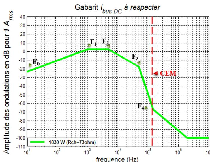
Fig. 78 Gabarit du courant de bus  $I_{DC}$
