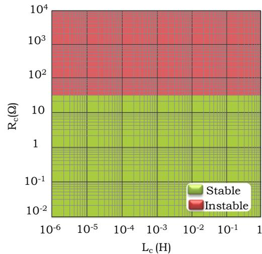
Fig. 118 Abaque stabilité du système donnée par Fig. 116 (b)
