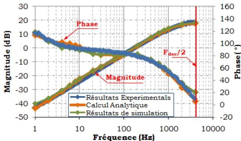
Fig.54 Comparaison des résultats de caractérisation du drive Laplace issus des méthodes théorique, simulation et expérimentale.
