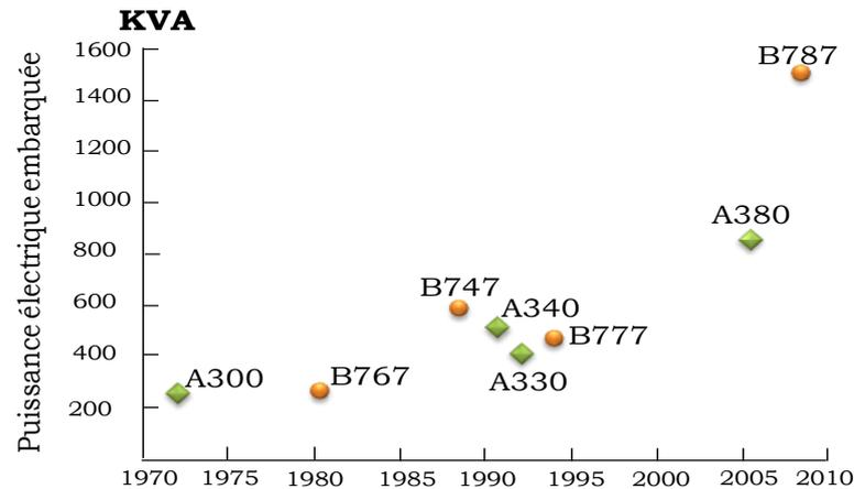
Fig.4 : Evolution de la puissance électrique embarquée (CLA,05)
