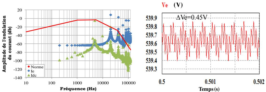
Fig. 95 Résultats de simulation de l'ensemble du système :  $F_{gen} = 800Hz$
