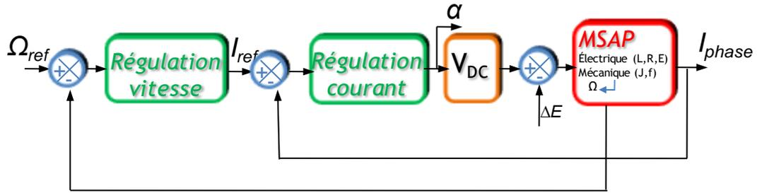
Fig.57 Boucle de régulation globale du drive Technofan
