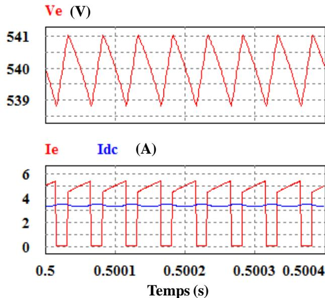
Fig. 84 Résultats de simulation ( $L_f=63\mu\text{H}$ ,  $C_f=24\mu\text{F}$ )
