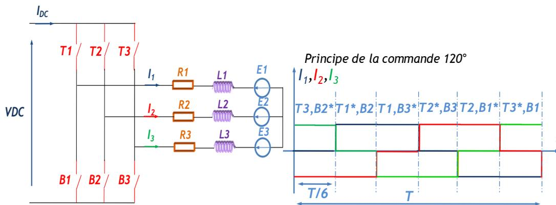
Fig.55 Principe de la commande du drive Technofan.
