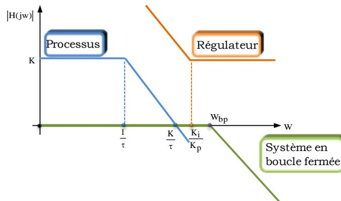
Fig.31 Principe de calcul des paramètres de régulateur
