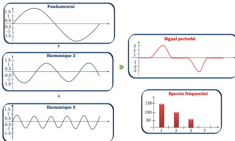
Fig.12 Déformation du signal électrique
