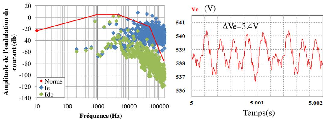
Fig. 105 Résultat de simulation ( $L_f=26\mu\text{H}$ ,  $C_f=92\mu\text{F}$ ,  $R_d=1.73\mu\Omega$ ,  $C_d=6.37\mu\text{F}$ )
