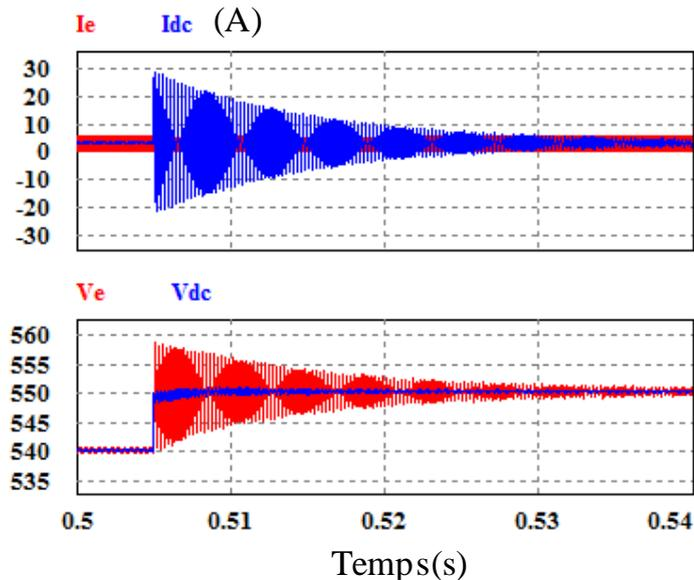
Fig. 99 Réponse du système en appliquant un échelon de 10V sur la tension de bus
