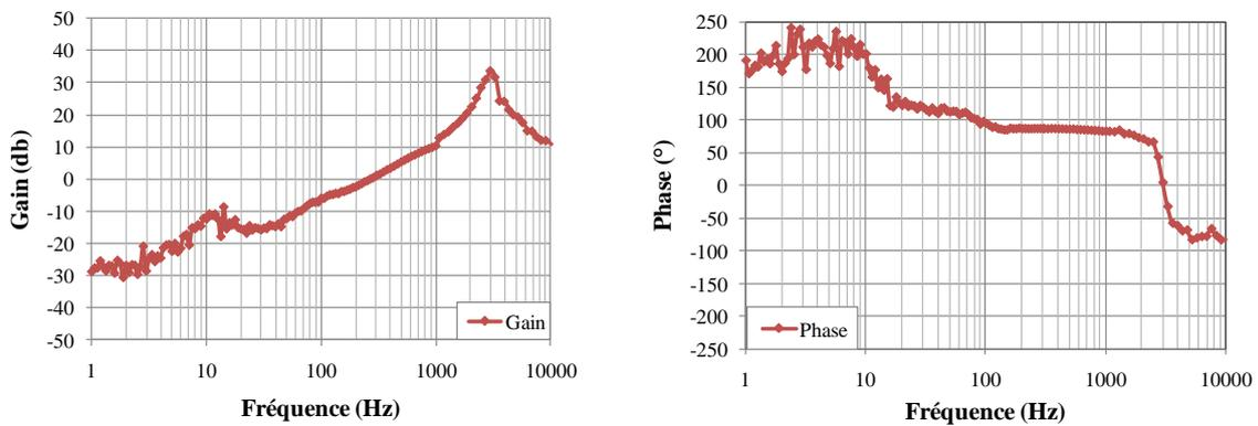
Fig.61 Admittance équivalente du drive Liebherr (3ème point)
