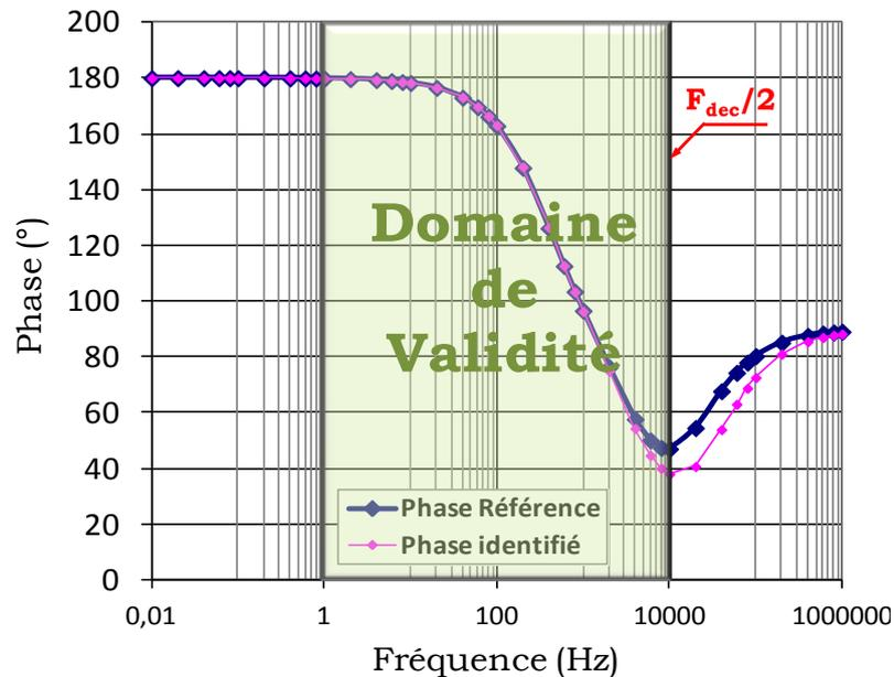
Fig. 72 : Comparaison de la phase des modèles analytique et identifié (hacheur)
