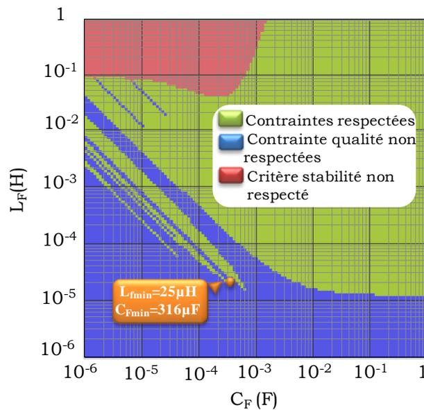
Fig. 101 ABAQUE de dimensionnement du filtre associé au moto-ventilateur
