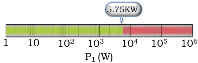
Fig. 125 Abaque de stabilité en fonction de la puissance (un seul équipement connecté)
