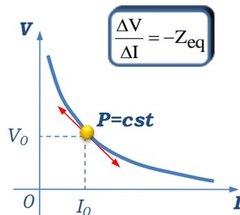
Fig.10 Représentation d'une charge à puissance constante
