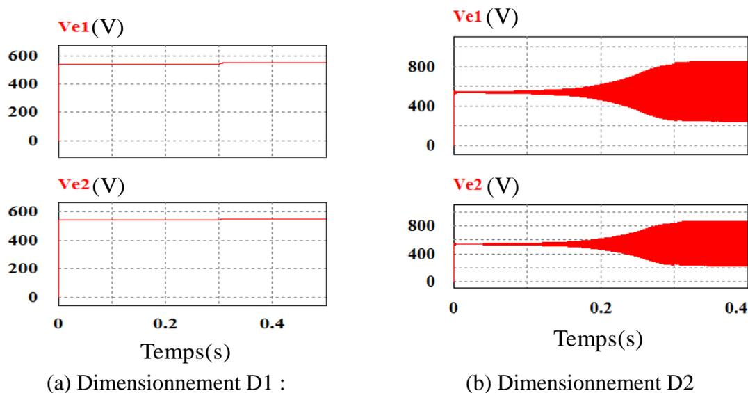
Fig. 124 Evolution des tensions aux bornes des équipements
