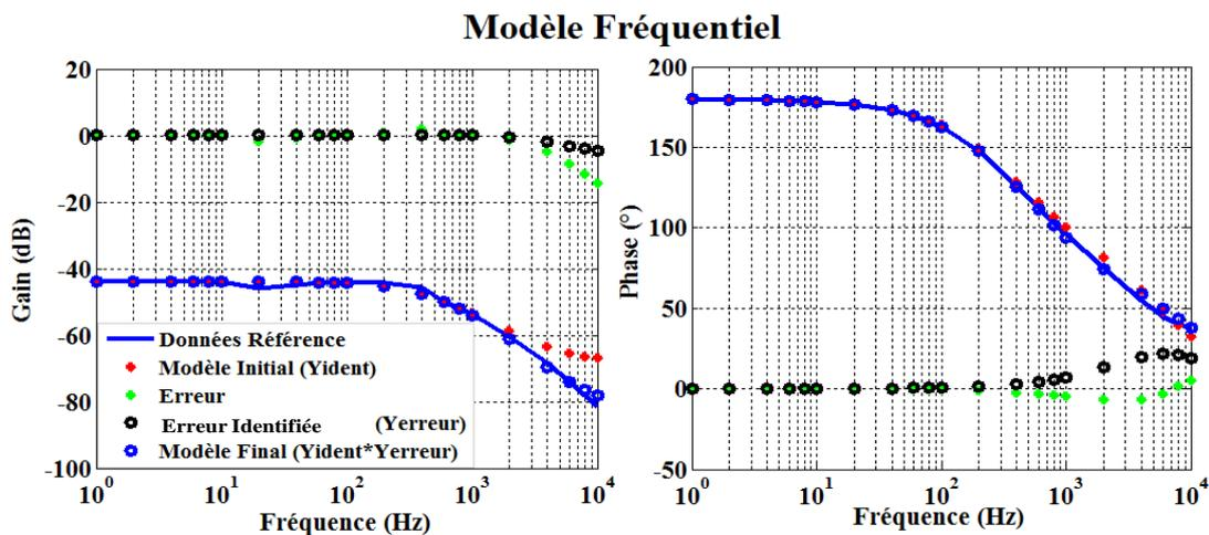
Fig. 67 : Identification du modèle équivalent du hacheur dévolteur+(RL)
