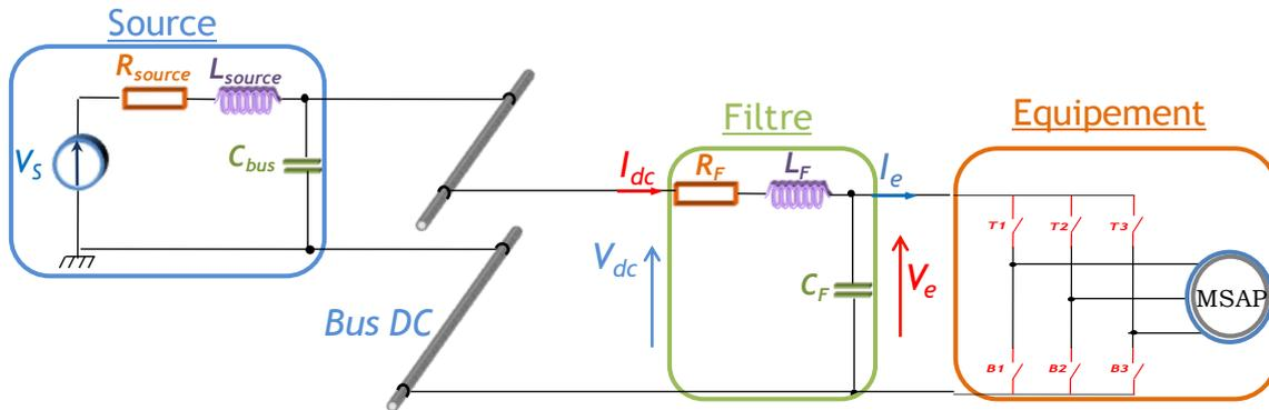
Fig. 100 Le système étudié: source+filtre ( $L_f$ ,  $C_f$ )+moto-ventilateur
