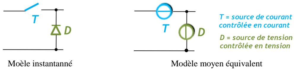
Fig.32 Modèle moyen de la cellule de commutation
