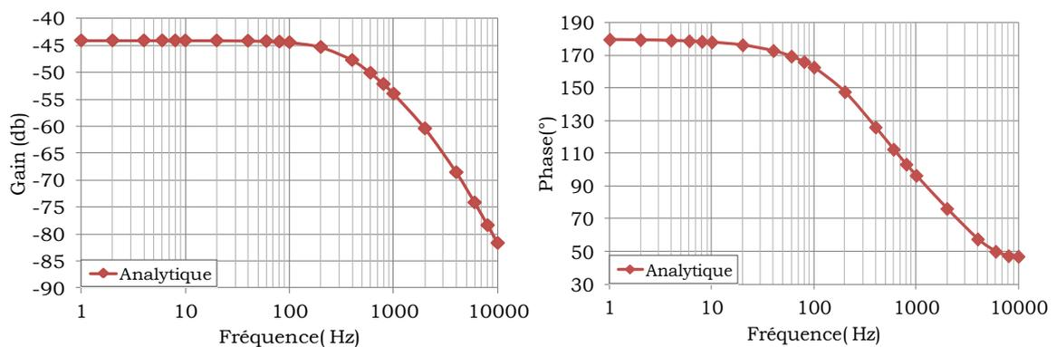
Fig.35 Diagramme de Bode de l'admittance équivalente  $Y_{eq}$
