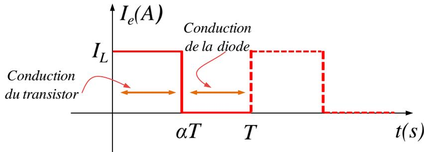
Fig.29 Principe de l'extraction de l'admittance équivalente
