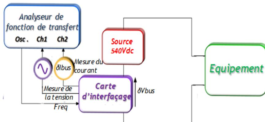
Fig.39 Schémas simplifié de la méthode de la caractérisation par l'approche expérimentale
