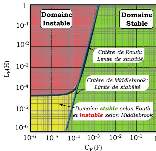
Fig. 24 Dimensionnement de filtre  $[L_F, C_F]$  :
