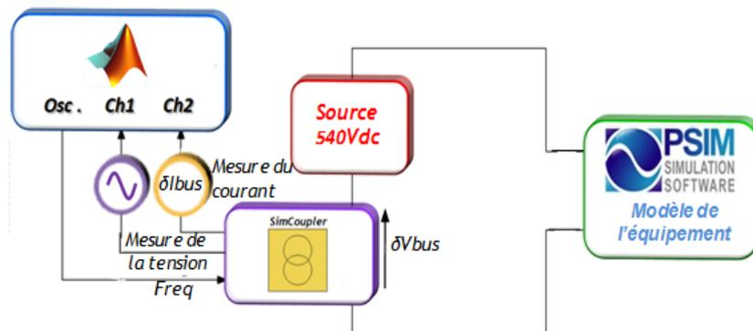
Fig.37 Principe de couplage *PSIM-MATLAB*
