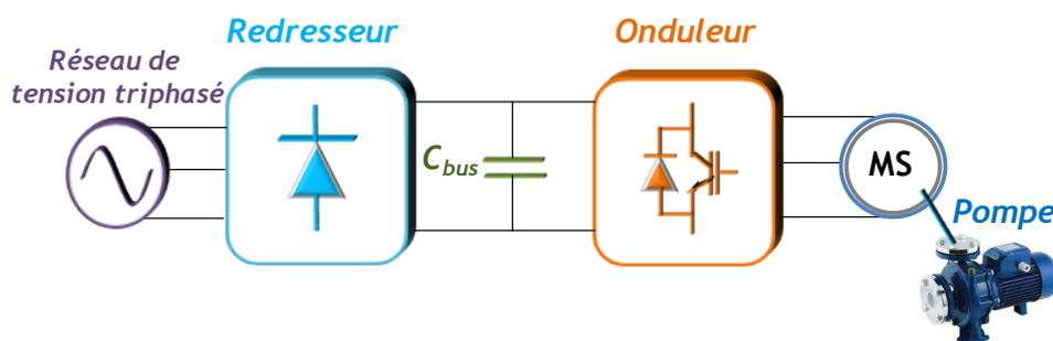
Fig.2 Schéma de principe d'un Actionneur Hydro-Electrique (EHA)
