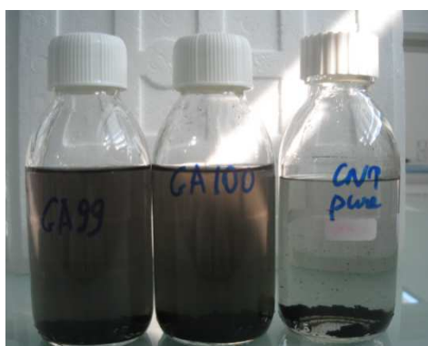
Figure III.16 Suspensions de CNTs non fonctionnalisés (à droite) et fonctionnalisés par la terpyridine (deux flacons à gauche) après une nuit.
