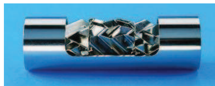
Figure 1-5: Mélangeur statique constitué de trois éléments Sulzer SMV™ inclinés successivement à 90° (Sulzer, 2014).
