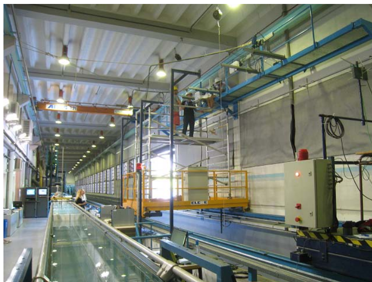
FIGURE 3.4 – Nouvelle plateforme dans le canal à houle CIEM pour fixer le dispositif optique (Mai 2012).
