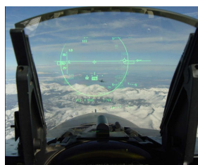
FIGURE 1.3 – Affichage tête-haute pour un pilote de chasse
