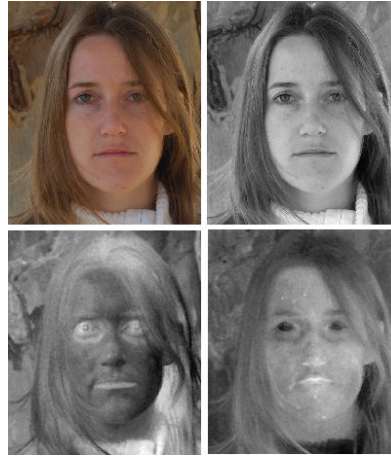
FIGURE 3.13 – Décomposition de l'image (en haut à gauche) en les canaux Y (en haut à droite), Cb (en bas à gauche) et Cr(en bas a droite).
