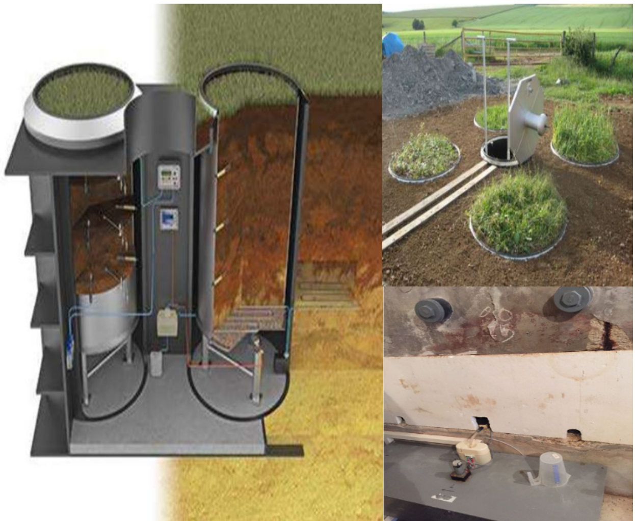
Figure 2.5: Les lysimètres: a) schéma d'une colonne lysimétrique, b) surface et occupation de sol pour des lysimètres, c) augets basculeurs mesurant le drainage à la base d'un lysimètre.
