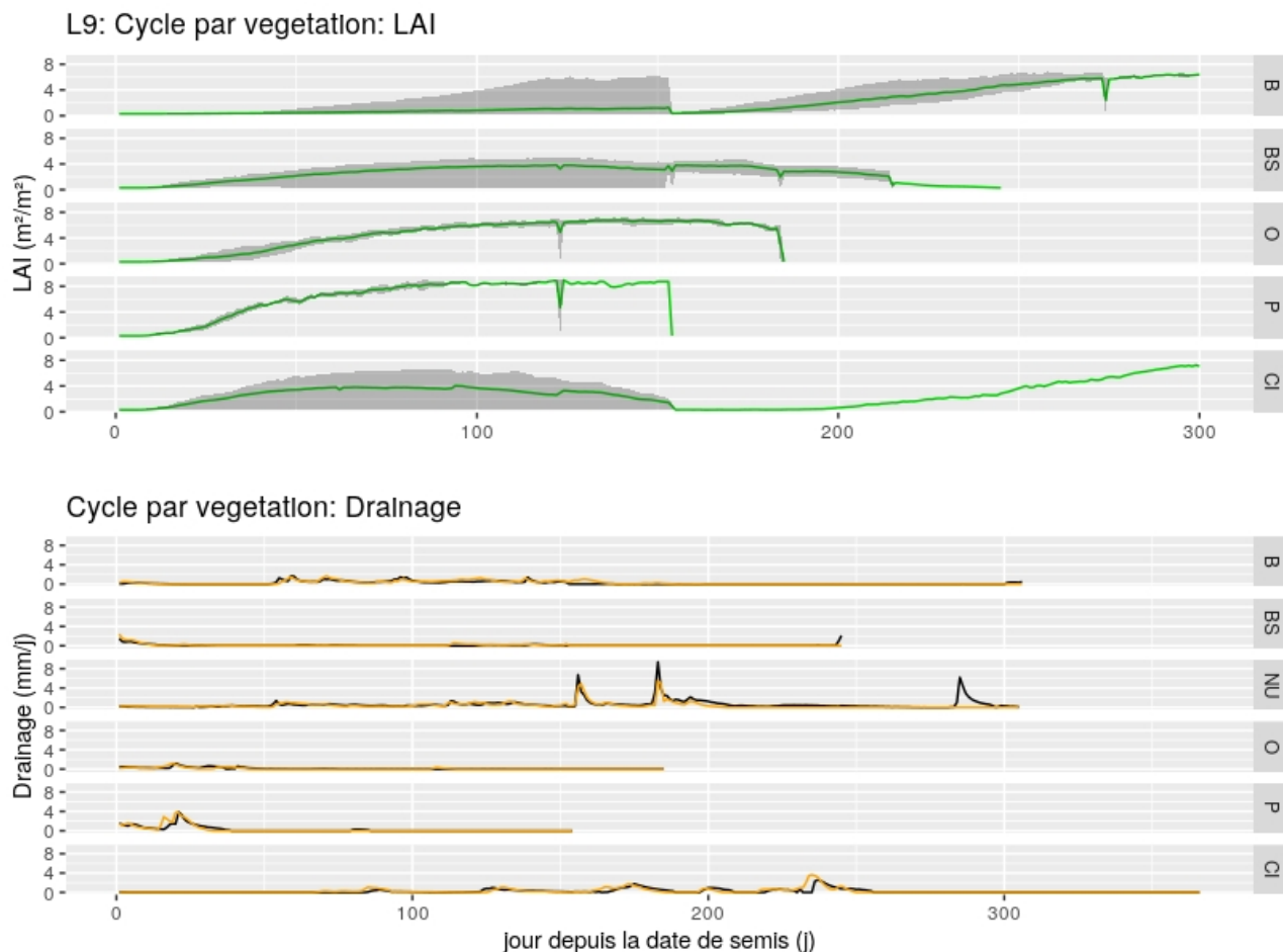
Figure 5.10: Sur le lysimètre L9 : cycles moyens annuels de LAI simulé (moyen, minimal et maximal) et de drainages observés (noir) et simulés (orange) par VGC pour chaque occupation du sol, depuis la date de semis (attention, les dates diffèrent d'une végétation à l'autre).
