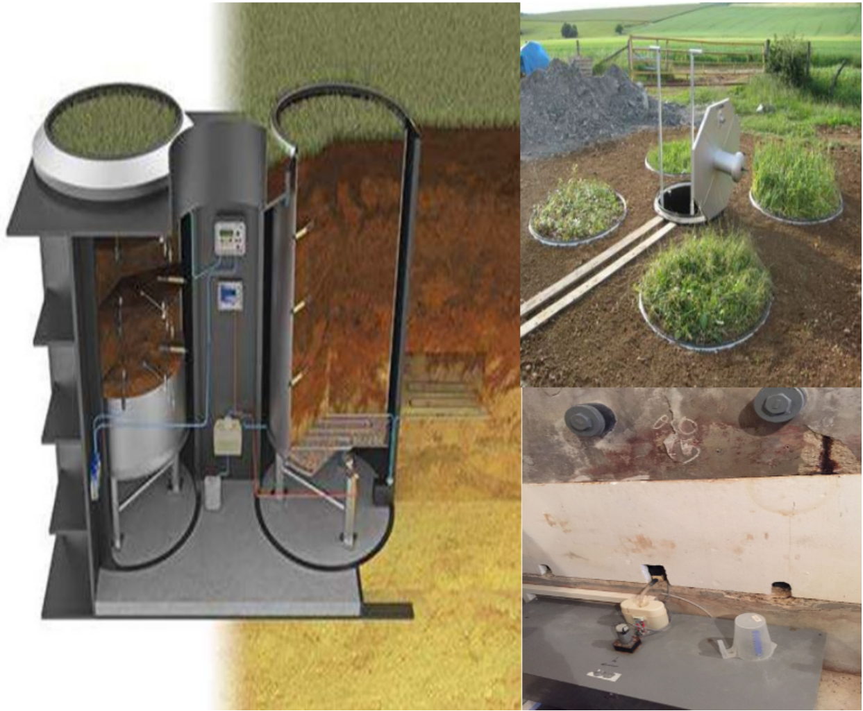
Figure 3.2: Les lysimètres: a) schéma d'une colonne lysimétrique, b) surface et occupation de sol pour des lysimètres, c) augets basculeurs mesurant le drainage à la base d'un lysimètre.
