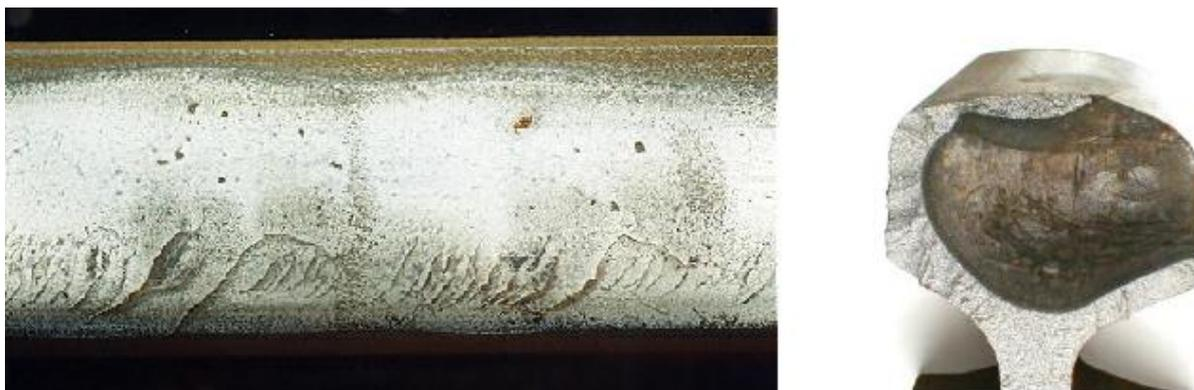
Figure 1-28. Défaut Head-Check sévèrement développé, (Dollevoet, 2010)
