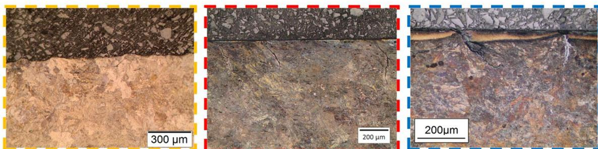
Figure 3-5 : Micrographies optique de la proche surface du rail, respectivement dans les bandes longitudinales a) II, b) III et c) IV
