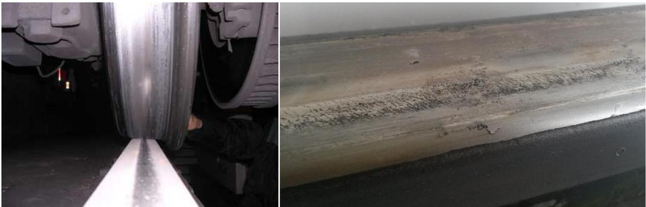
Figure 1 : La sévérité des conditions de contact roué/rail entraîne la fissuration des rails en service.
