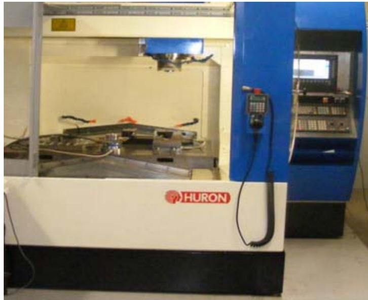
*Figure III.1.5 : Machine-Outil Huron KX10*
