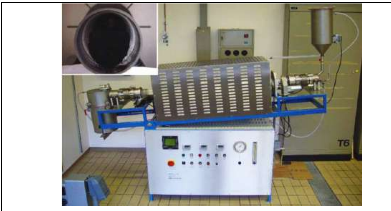
Figure 1.18 : Photographie d'un réacteur tournant pour la production par C-CVD de MWCNTs (d'après [73])
