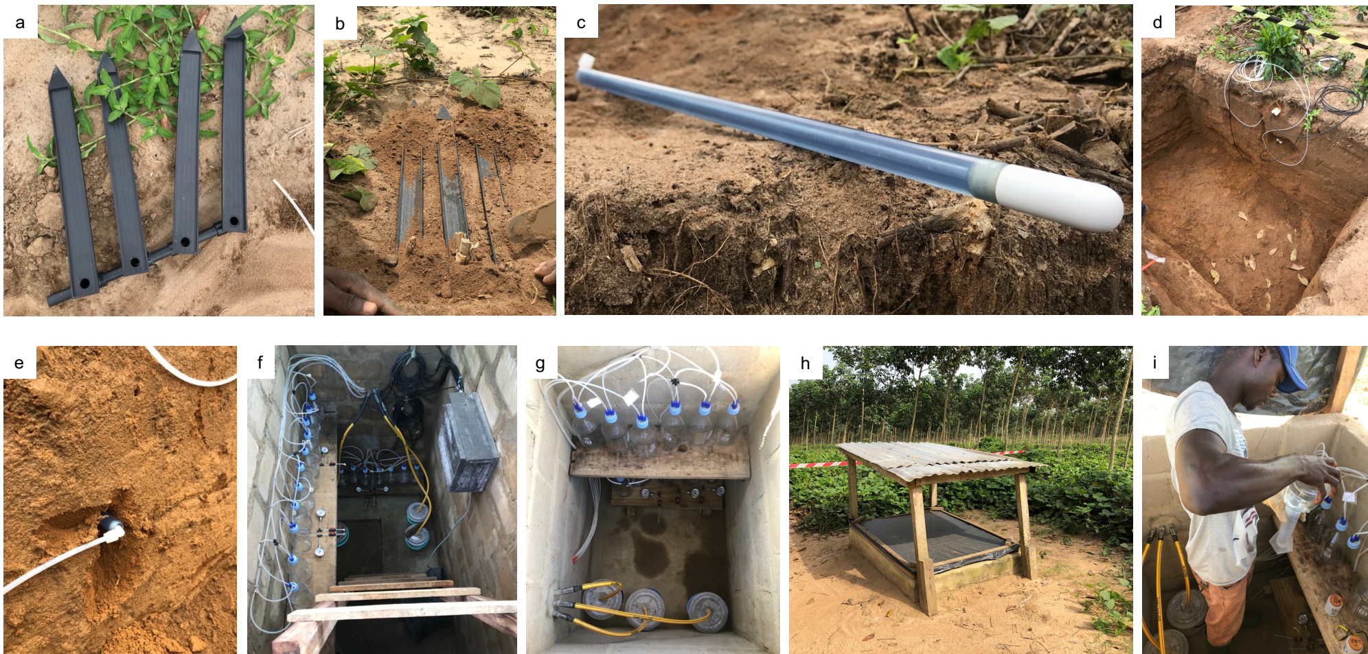
Photo 8 : Le dispositif lysimétrique à la SAPH. Fluteau avant installation dans le sol (a) ; fluteau en cours d'installation (b) ; bougie poreuse avant insertion dans le sol (c) ; fosse de réception (d) ; bougie poreuse insérée horizontalement dans le sol (e) ; fosse de récolte du traitement R2F1 du bloc 1 (f) ; fosse de récolte du traitement R0F0 du bloc 3 (g) ; fosse de récolte du traitement R2F0 du bloc 2 (h) ; récolte d'eau hebdomadaire (i).
