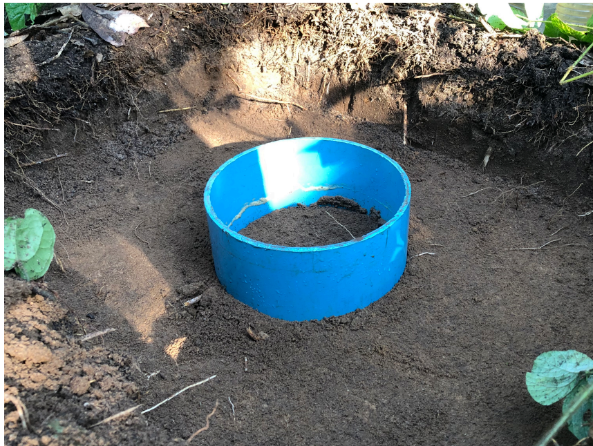
Photo 9 : Cylindre pour le test de Beerkan à 15 cm de profondeur en position P3 (au milieu de l'interligne), permettant la détermination de la conductivité hydraulique à saturation ( K_s ).
