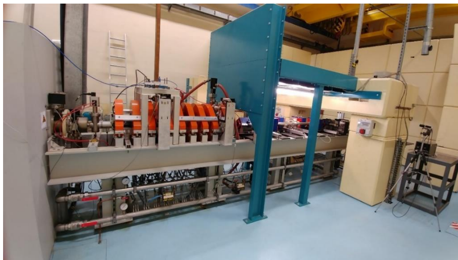
Figure 2.4. Photographie de l'accélérateur linéaire d'électrons ALIENOR.
