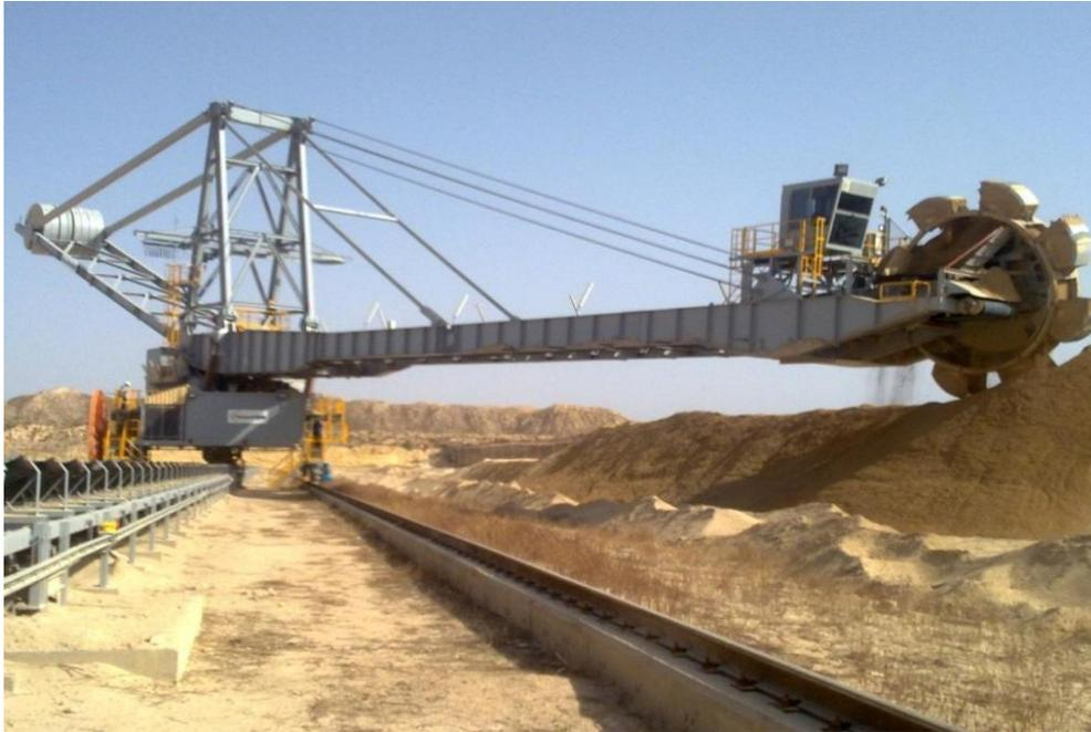
Figure 1-6 : Déstockage du phosphate à l'aide d'une roue-pelle
