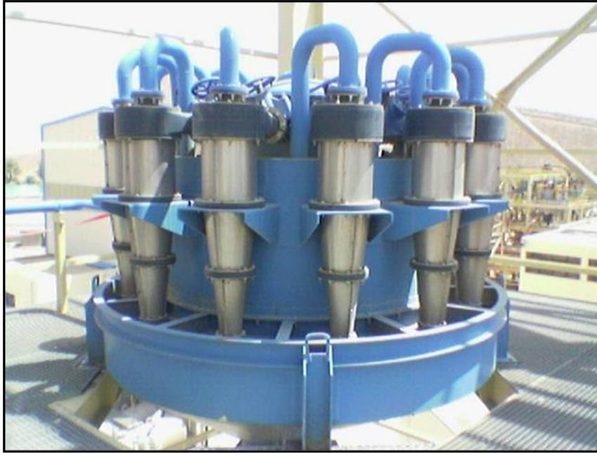
Figure 1-7 : Batterie d'hydrocyclones séparateurs
