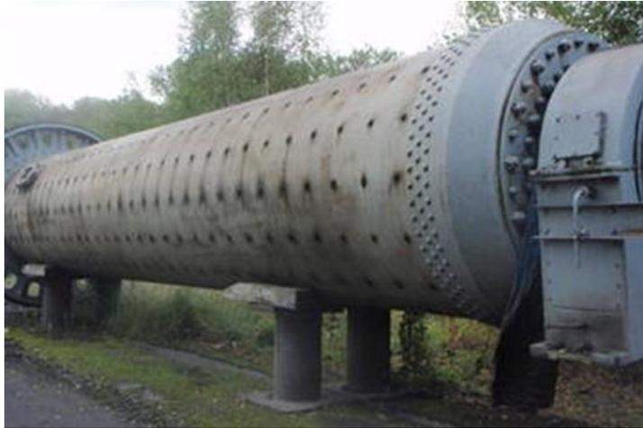
Figure 1-9 : Broyeur à boulets
