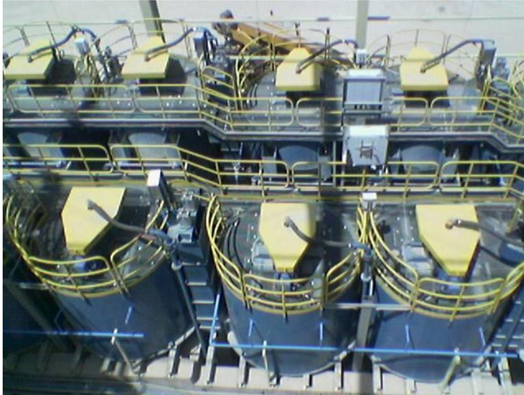
Figure 1-8 : Cellules de flottation
