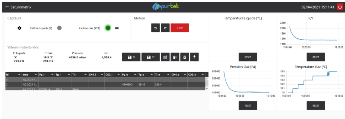
FIGURE III.10 – Interface du Saturométrie pendant une mesure de constante de Henry.
