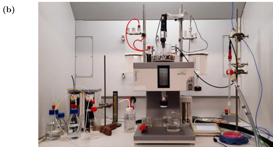
FIGURE 1.5 – Schéma (a) et photographie (b) du réacteur de synthèse automatisé utilisé pour la synthèse des CaPs.
