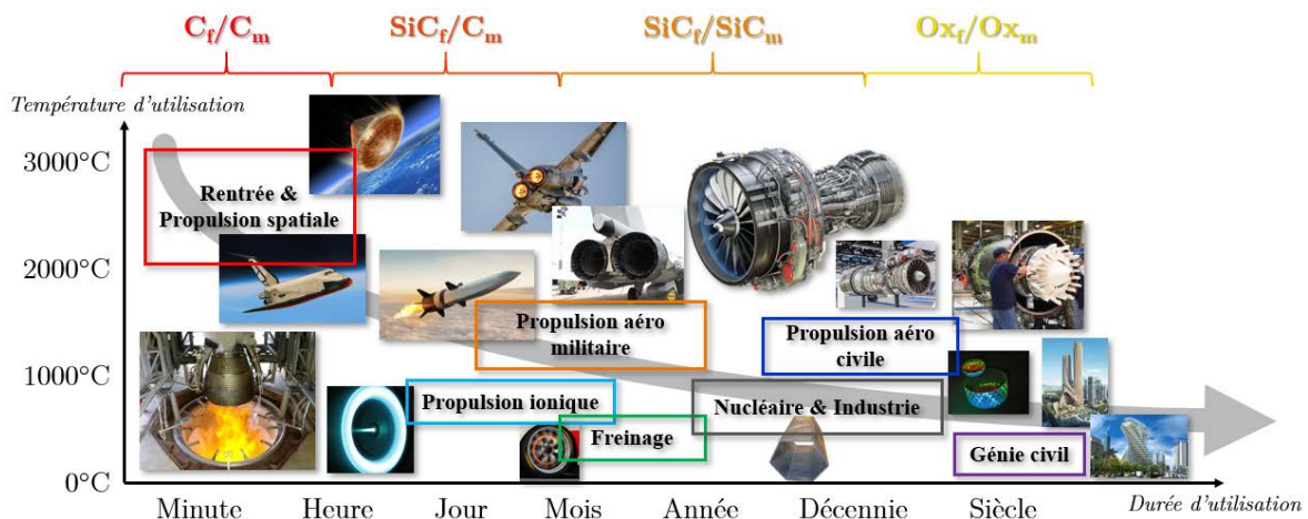
FIGURE 1.1 – Températures et temps d'utilisation de différentes catégories de CMC. Adapté de [6].
