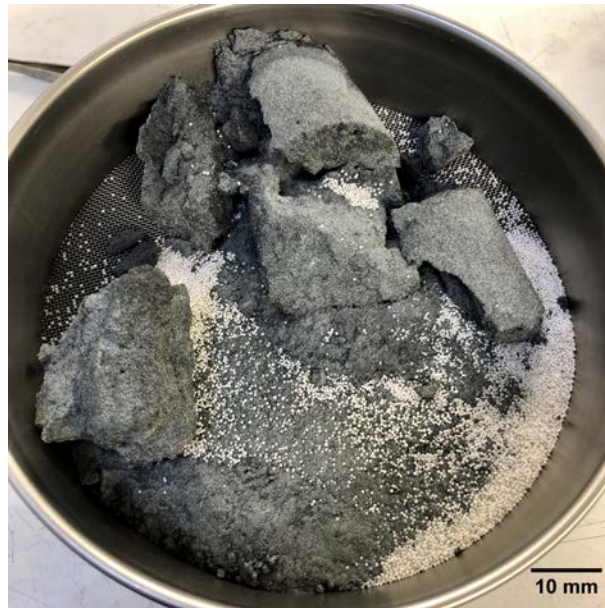
FIGURE 3.9 – Image d'un lit de fibres courtes après fluidisation à 200°C.
