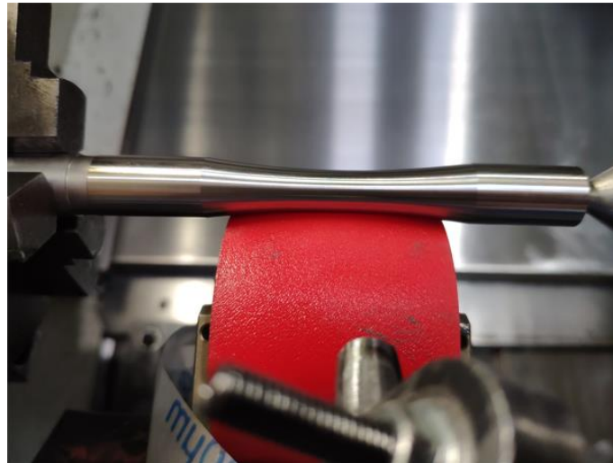
Figure 283. Géométrie de galet utilisée dans pour le toilage des éprouvettes de fatigue
