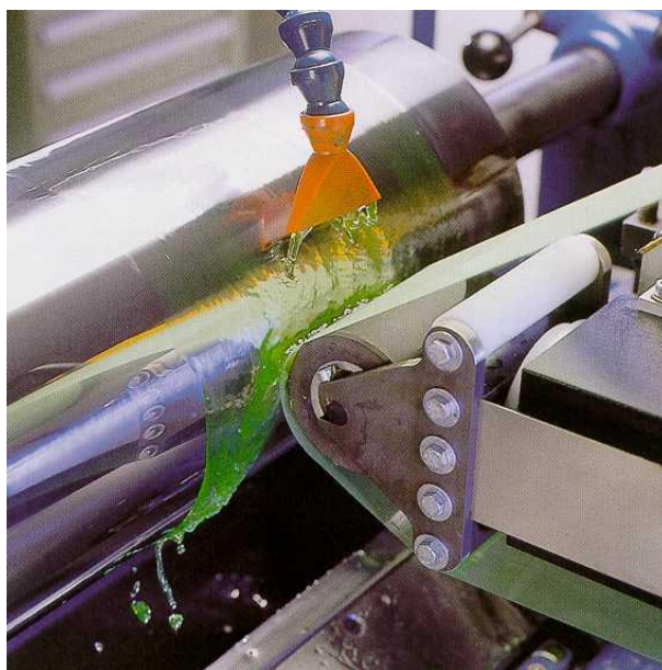
Figure 6. Illustration du procédé de toilage en application industrielle (Supfina)
