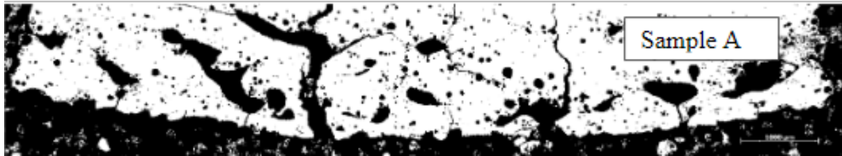
Figure 30 : Image du phénomène de délamination des échantillons du plateau de fabrication [59]
