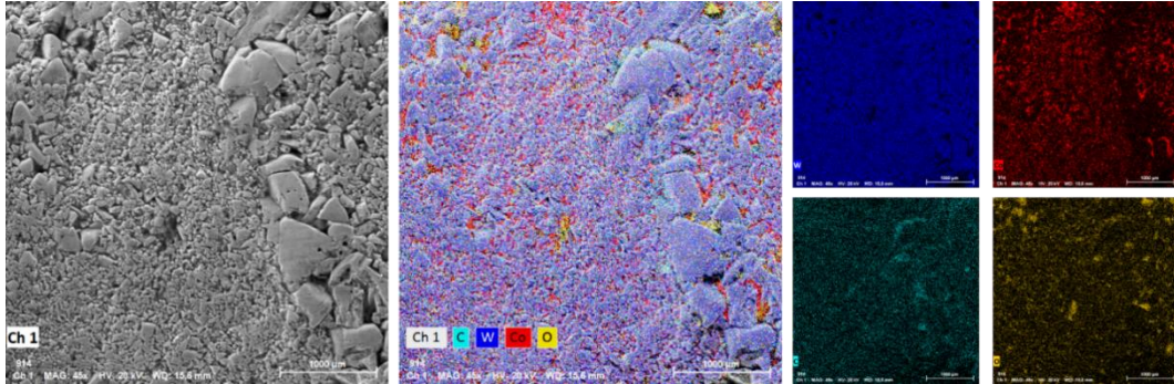
Figure 126 : Cartographie MEB/EDX de l'empreintes d'usure de l'échantillons WC-Co HIP
