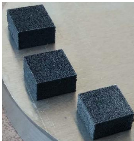
Figure 27: Cubes produit à partir de la poudre de WC-17Co agglomérée frittée [58]
