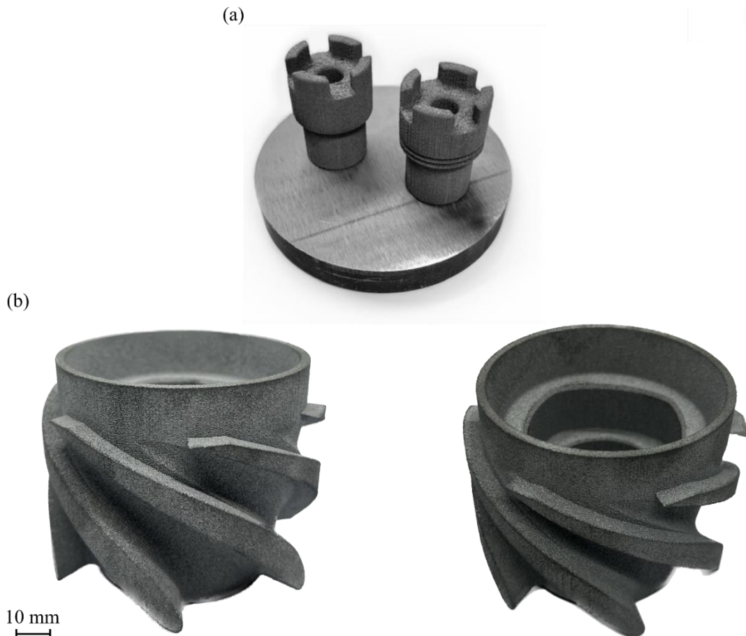
Figure 131 : Fabrication de démonstrateur à base de carbure cémenté par procédé L-PBF, (a) outil de buse de forage interchangeable et (b) une tête de forage pétrolier
