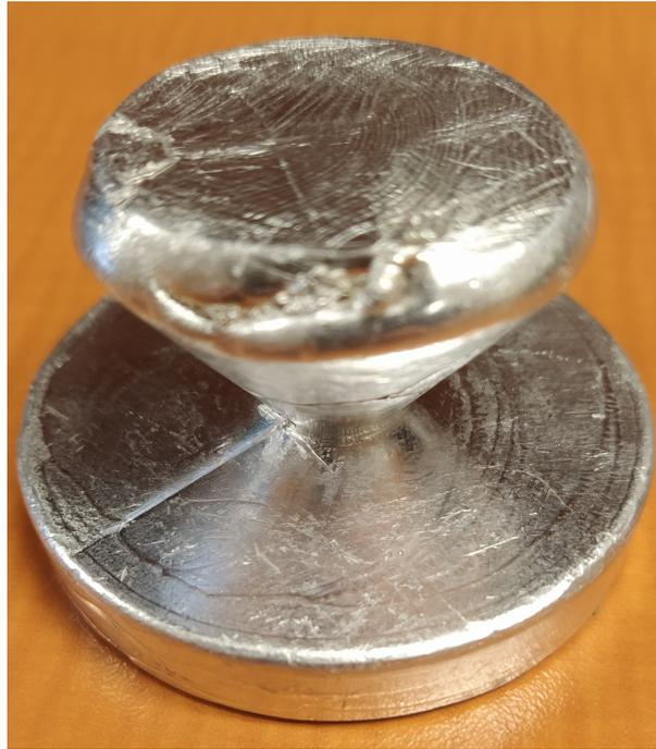
FIGURE 2.4 – Échantillon d'aluminium pur avant usinage.
