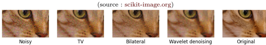
Figure 2.14 – Comparaison des méthodes de débruitage
