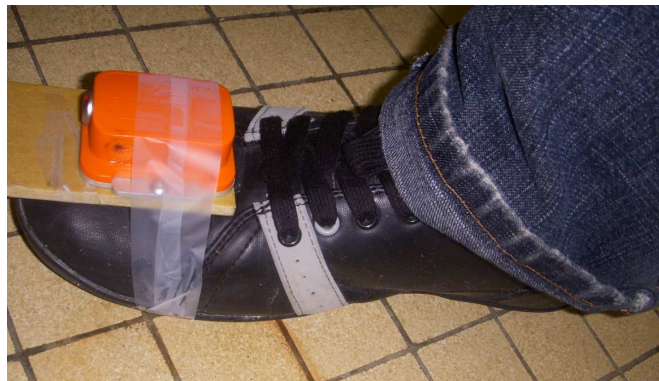
Fig. 5.2. Centrale d'attitude MTi attachée au pied d'un sujet au cours du déplacement
