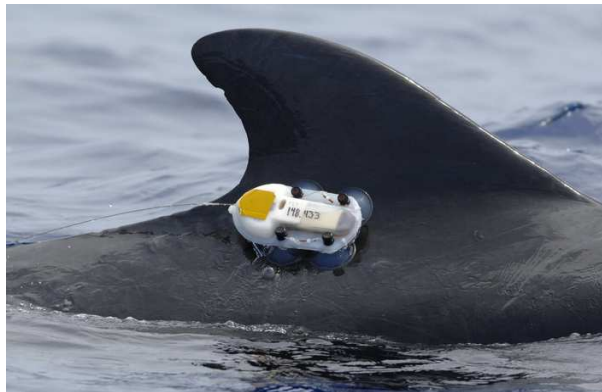
Fig. 2.14. Bio-logger contenant un accéléromètre et un magnétomètre triaxiaux, attaché à une baleine
