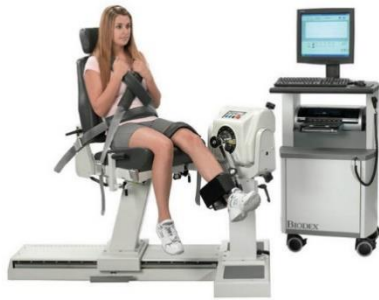
Figure 22: Ergomètre isocinétique BIODEX et protocole de flexion et extension de l'articulation du genou.
