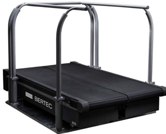
Figure 31 : Tapis roulant instrumenté BERTEC à double bande et plateformes instrumentés (bertec.com)
