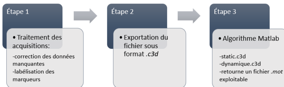
Figure 28 : Etapes nécessaires à l'exploitation des données OptiTrack
