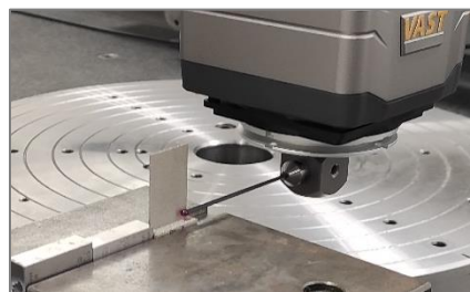
Figure 2.12 : Mur en cours de mesure par MMT
