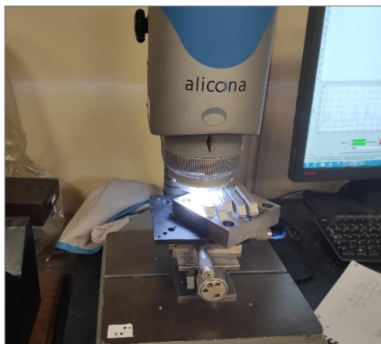
Figure 2.21 : Photo du profilomètre optique Alicona utilisé
