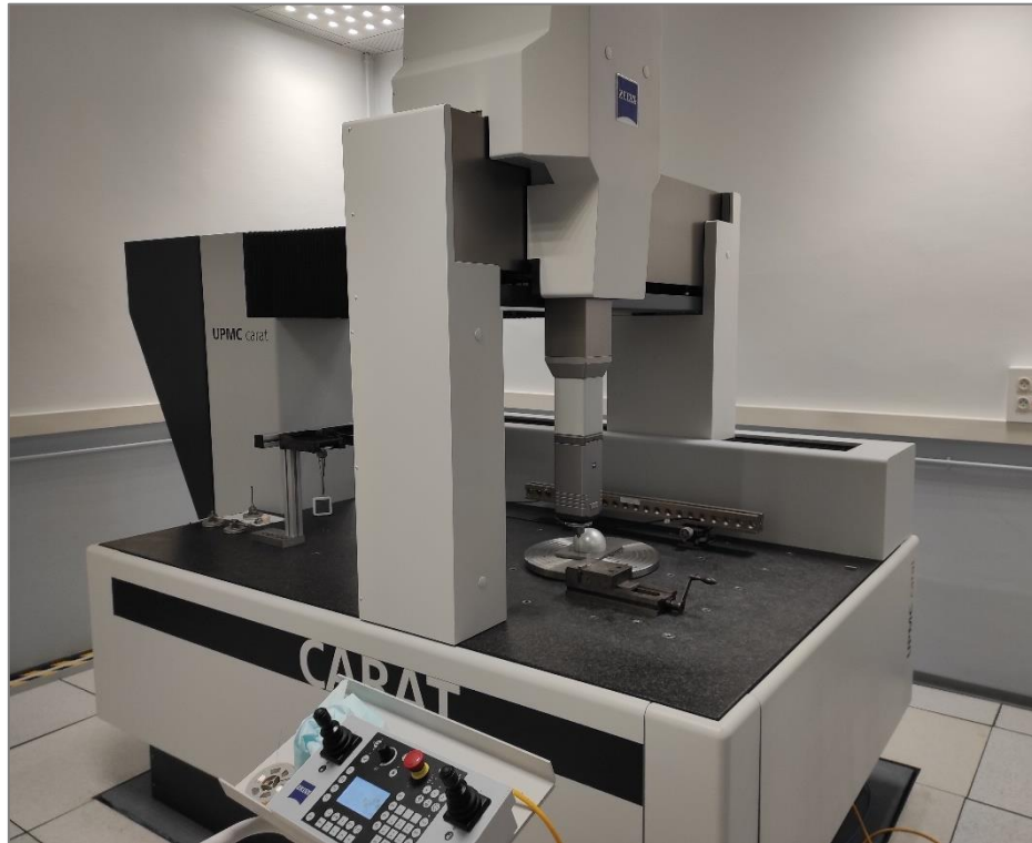
Figure 2.10 : Machine à Mesurer Tridimensionnelle, Zeiss CARAT
