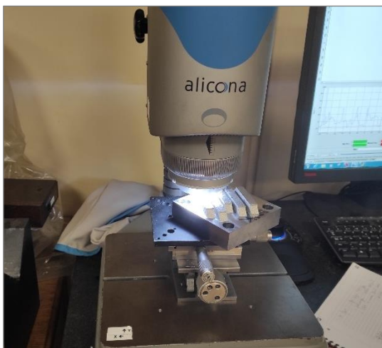
Figure 2.21 : Photo du profilomètre optique Alicona utilisé
