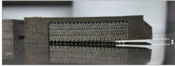
Figure 1.32 : Exemple de pièce présentant des déformations dues aux contraintes résiduelles lors du décrochage du plateau [67]
