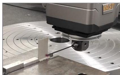
Figure 2.12 : Mur en cours de mesure par MMT
