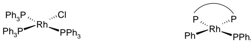
Figure III-9 : Géométrie (a) du complexe de Wilkinson, (b) du complexe  $[\text{RhPh}(\text{PPh}_3)\{\text{BINAP}\}]$ .
