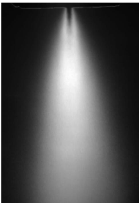
FIGURE A.1 – Image moyenne du spray sans contrôle
