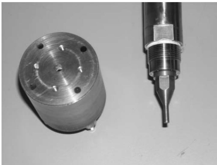
FIGURE 3.2 – Vue de la buse interne (1) et de la buse externe (2) de l’injecteur.
