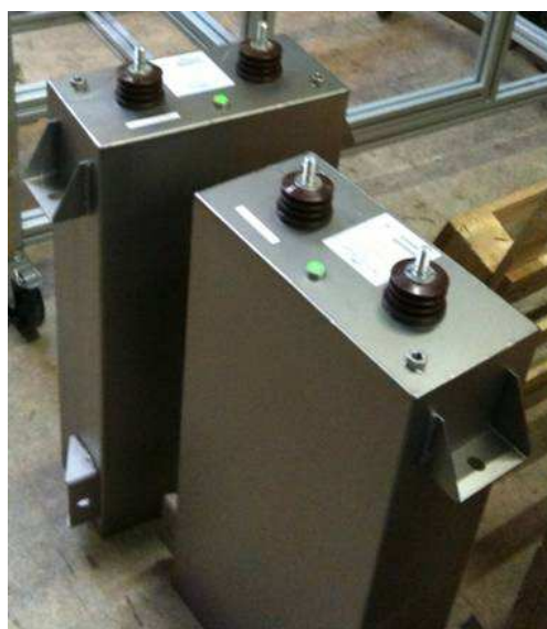
figure V.5 : Photo des condensateurs de sortie du compensateur
