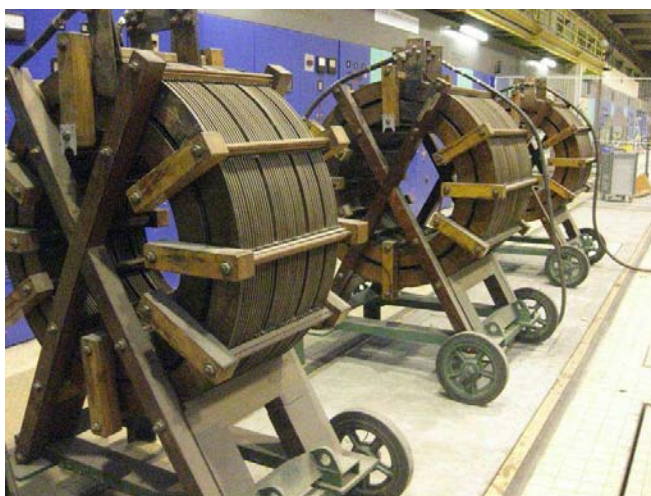
figure V.3 : Photo des bobines du filtre d'entrée de la maquette
