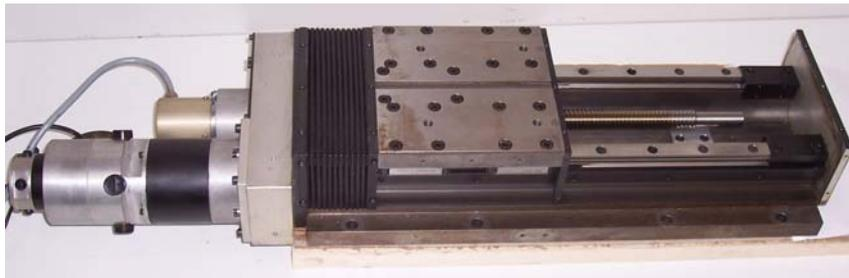
FIGURE 5.4: Entraînement électrique à courant continu
