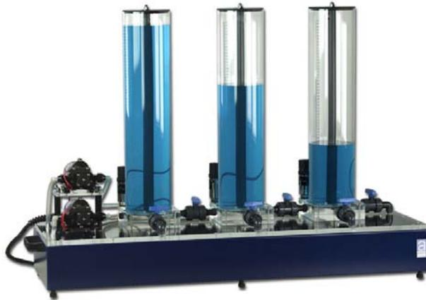
FIGURE 3.7: Système expérimental de régulation de niveau
