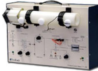
FIGURE 3.14: Processus thermique : Process Control Trainer 37-100
