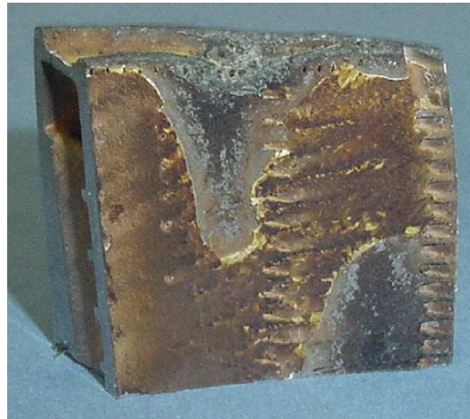
Figure I-3-12 : Barrière thermique infiltrée et délaminée après attaque par des CMAS fondus [221] .
