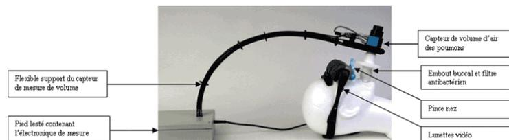
FIGURE 2.23 – Spiromètre de Dyn'r.
