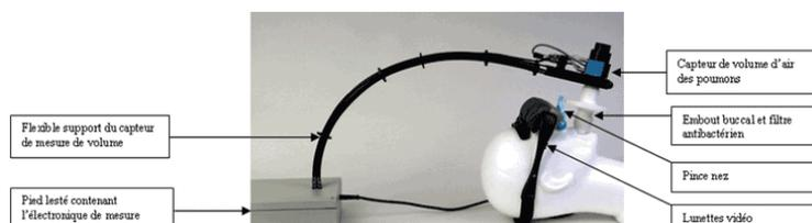
FIGURE 2.23 – Spiromètre de Dyn'r.
