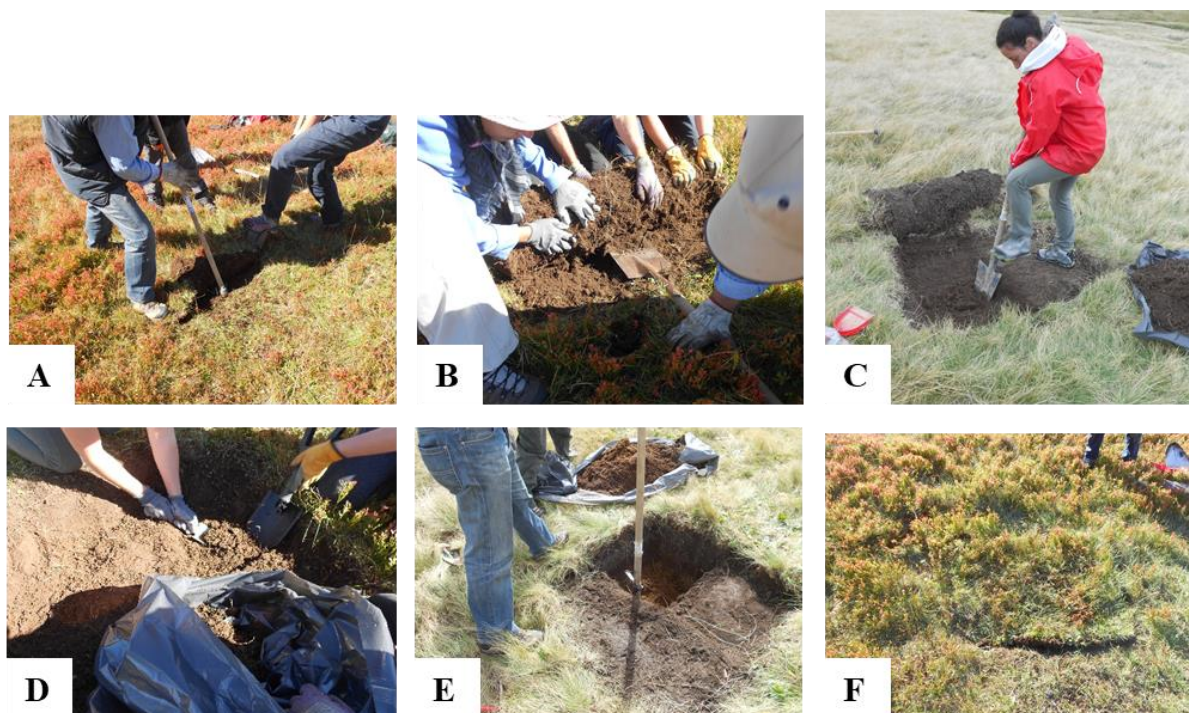
Figura 35. Alcune fasi del campionamento. A e B: rimozione della cotica erbosa; C, D e E: prelievo dei campioni; F: riposizionamento della cotica erbosa al termine del campionamento; (foto A. Benatti, M. Bal, S. Garcia Alvarez).
